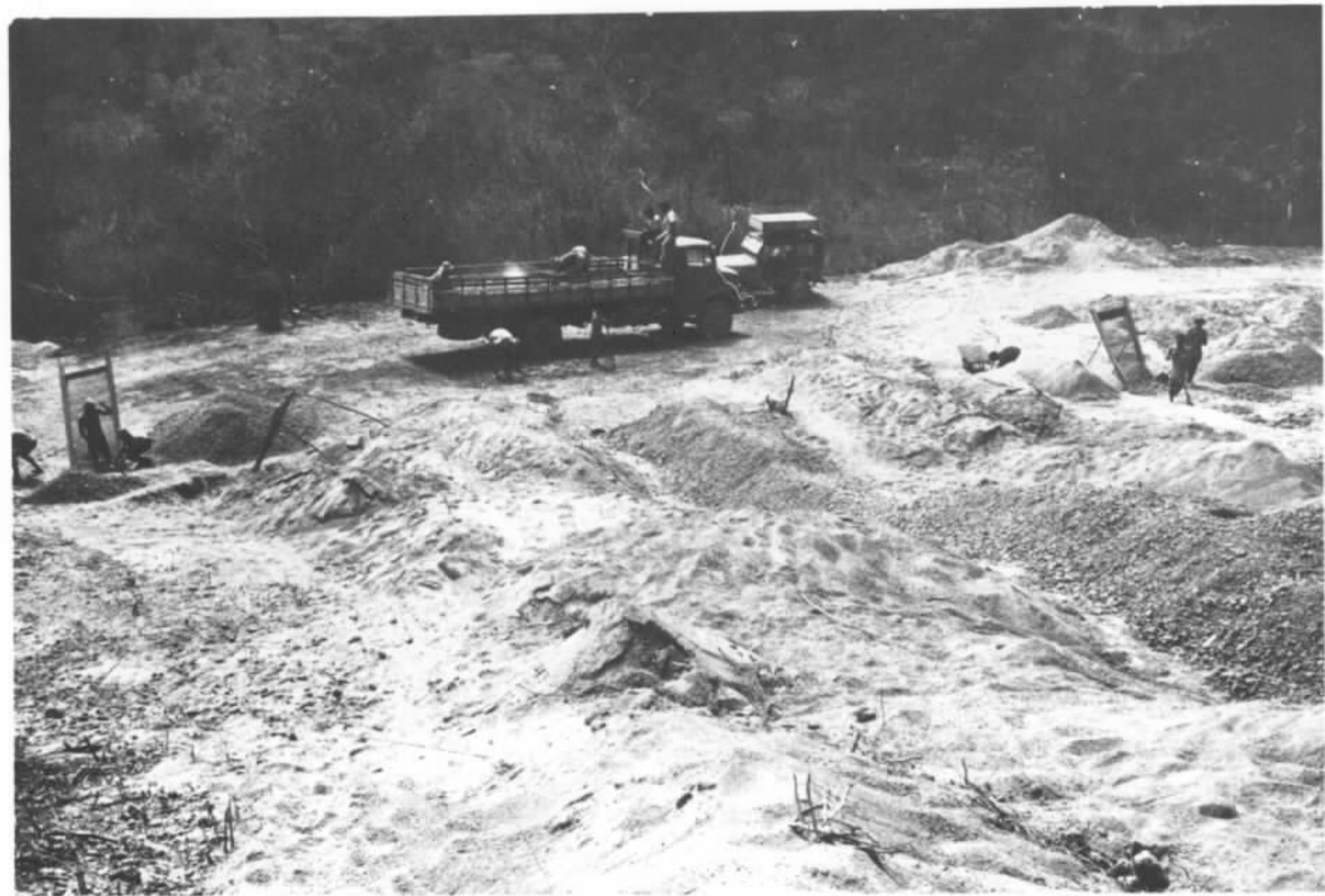
FOTO Nº 61 - Mina de manganês do Boqueirão do Pedrinho. Beneficiamento do minério de manganês retirado dos colúvios existentes sobre a Formação Caboclo.
