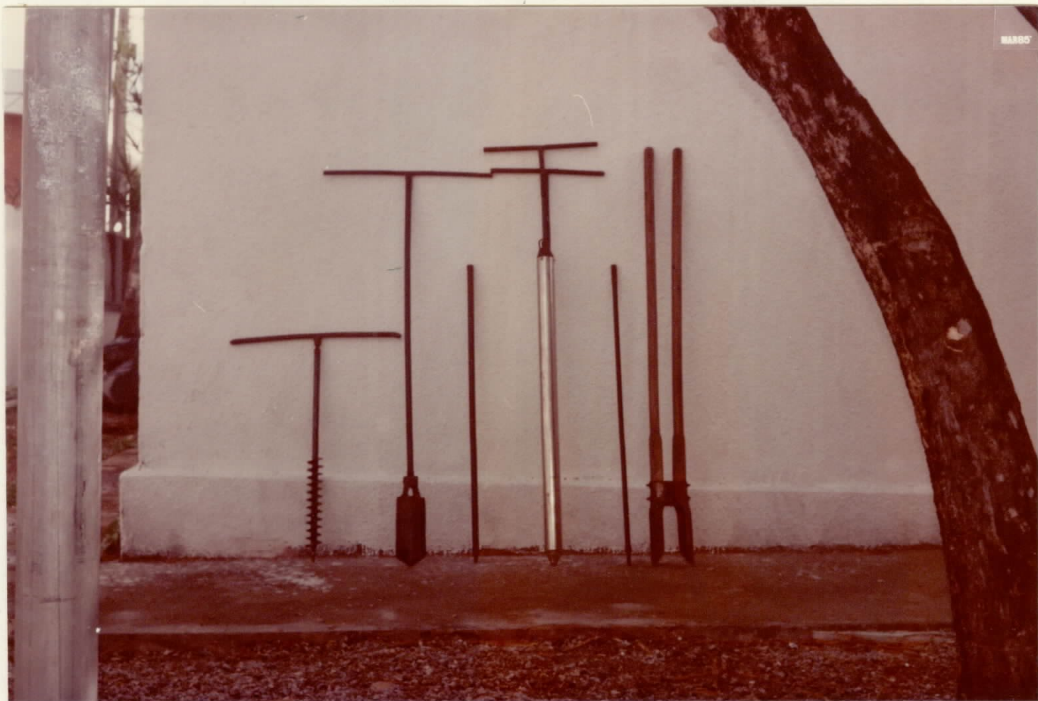
FOTO - 04 - Equipamentos empregados na sondagem e amostragem dos depósitos.
