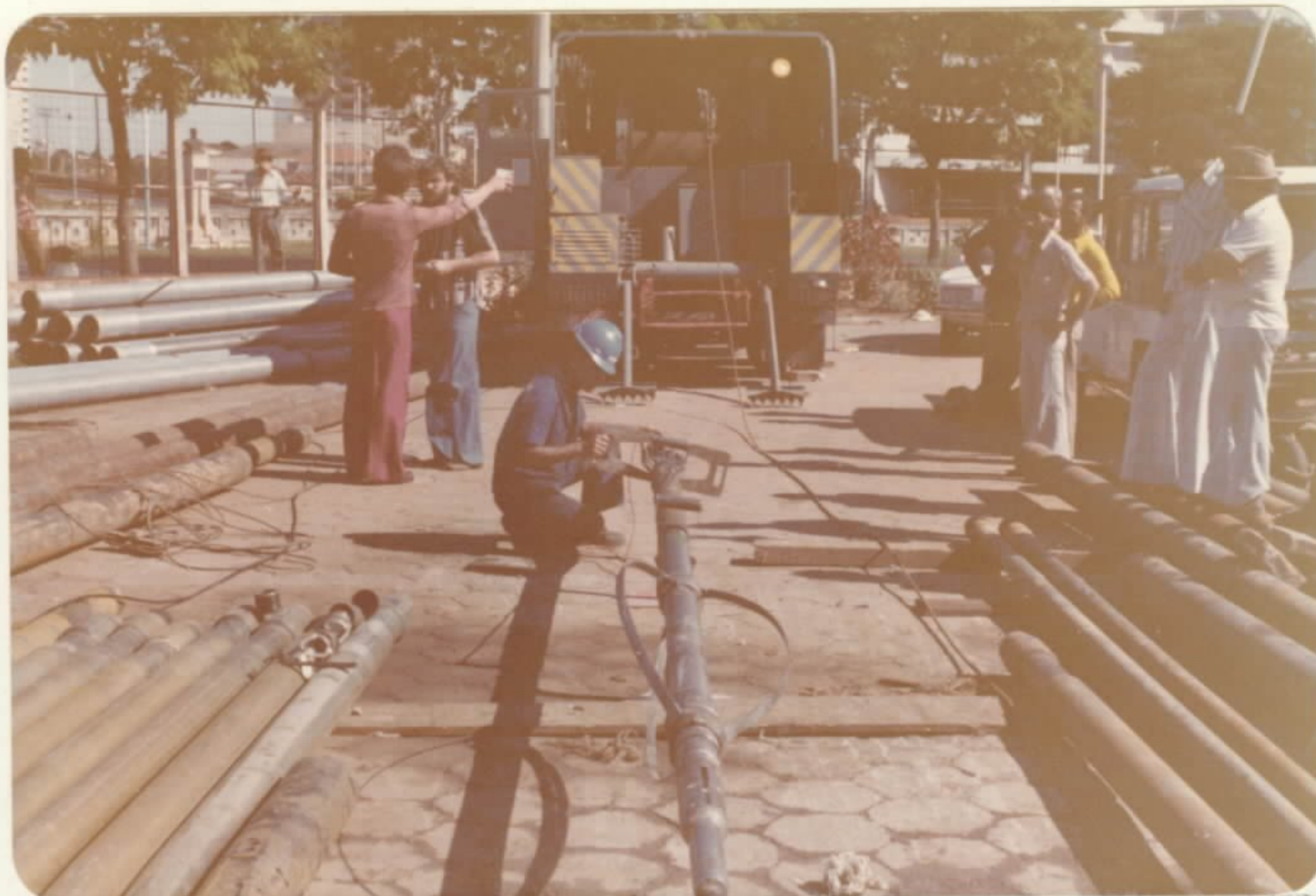
Sonda "Caliper" em fase de calibração inicial. Ao fundo unidade de perfilagem da DOWELL-SCHLUMBERGER
