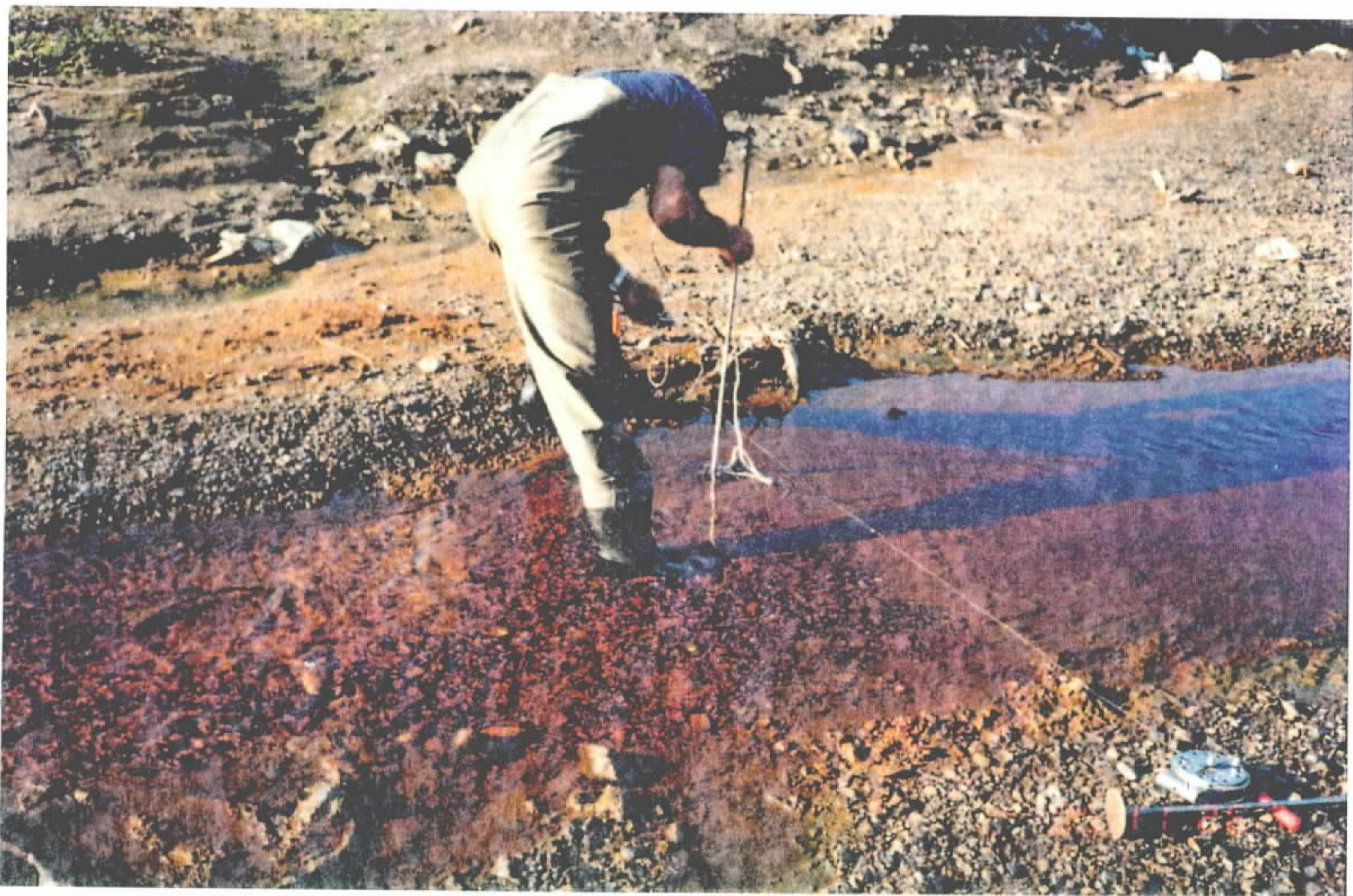
Foto 8 - Medição de vazão utilizando micromolinete. Rio Maina - Estação RM01 na ponte da Vila Visconde.
