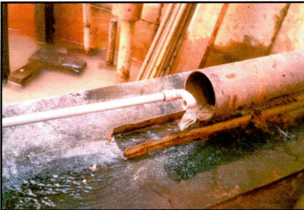
**Foto 10 - Sistema de limpeza com jato invertido.**
