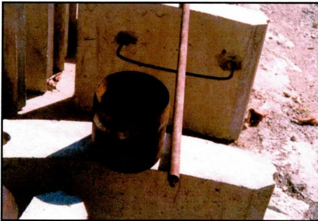
**Foto 6** - Sapata cortante utilizada na perfuração dos drenos e um tubo centralizador de 1".
