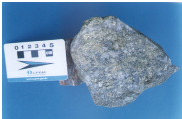
Figura 4.3 a – Detalhe do veio do Patinhas com ten do sulfetação abundante (estação LT-39).
