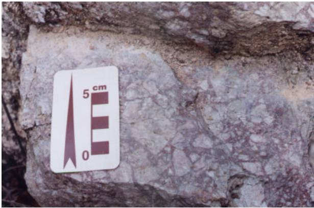
Figura 4.9 – Brecha hidrotermal no garimpo Céu Azul. Os fragmentos de quartzo encontram-se envolvidos por matriz sílica criptocristalina (estação AT-148).
