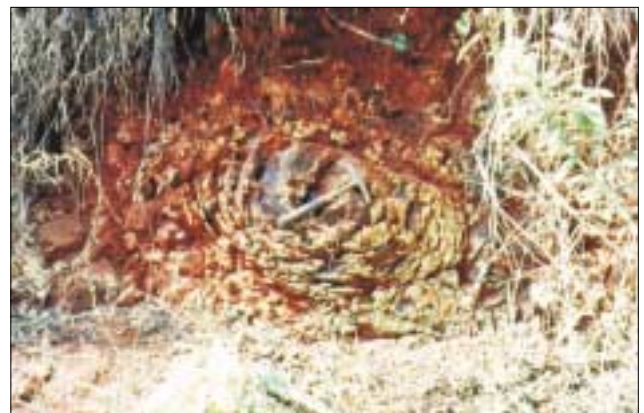
Foto 11 - Afloramento de basalto com denso sistema de fraturas dispostas em várias direções. Em função dessa geometria de fraturas é que se dá a decomposição esferoidal, pois as águas das chuvas infiltram-se e se armazenam nas fendas e progressivamente vão alterando a rocha de forma concêntrica.
