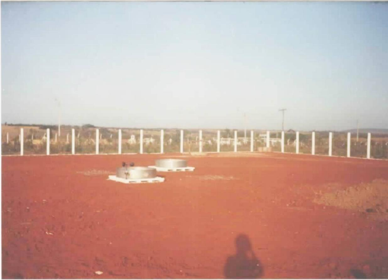
Tanque Evaporimétrico "Classe A"
