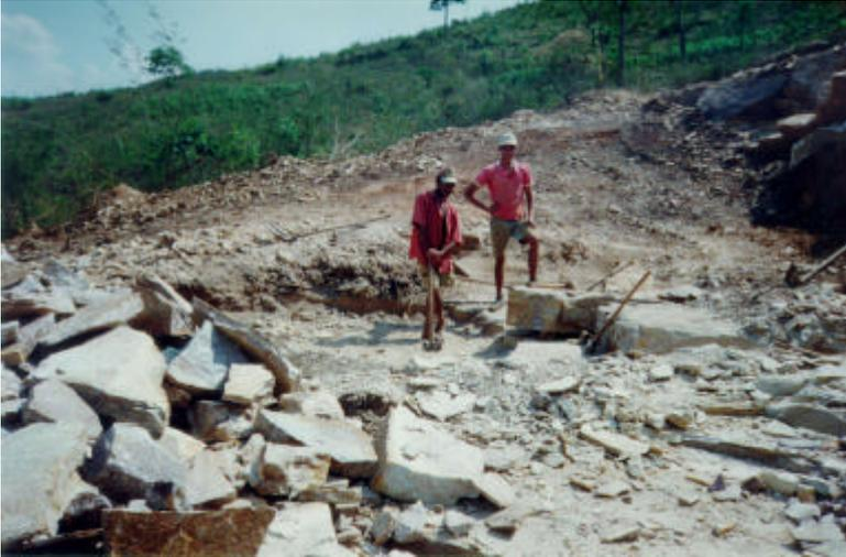
**FOTO 4.4** Extração manual de blocos de quartzito usados na construção civil.
