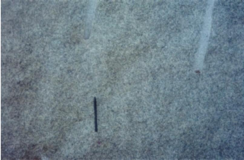
**Foto 2.22** - Granito Jaceguá. Biotita-alcali-feldspato granito, granulação média, rico em fenocristais de feldspato alongados e estreitos (1 cm de comprimento por 1-2mm de largura).
