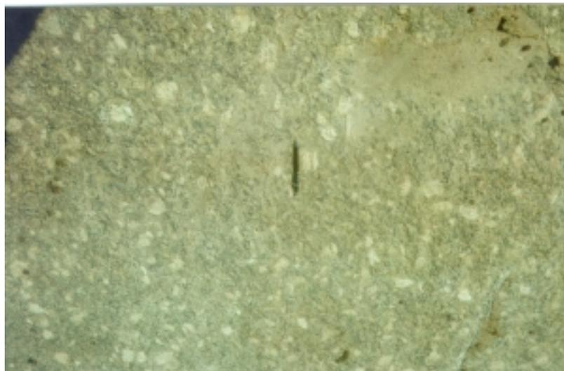
**Foto 2.8** - Leucogranito Carlos Chagas. Leucogranito porfiritico rico em pórfiros de feldspato com até 5 cm de comprimento, às vezes bem formados.
