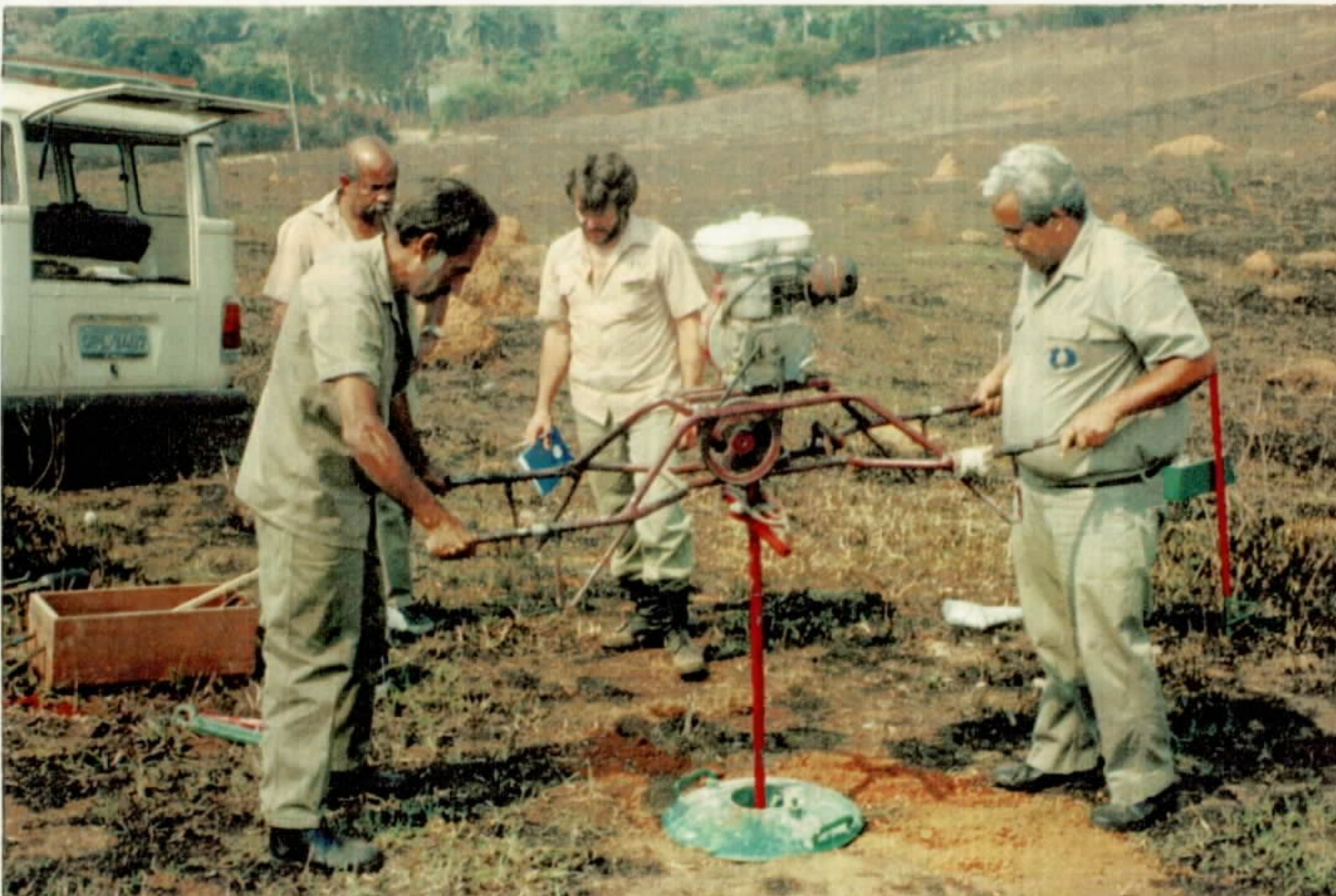
Foto 14: Prospecção geo técnica. Amostragem de solo através de trado mecânico.
