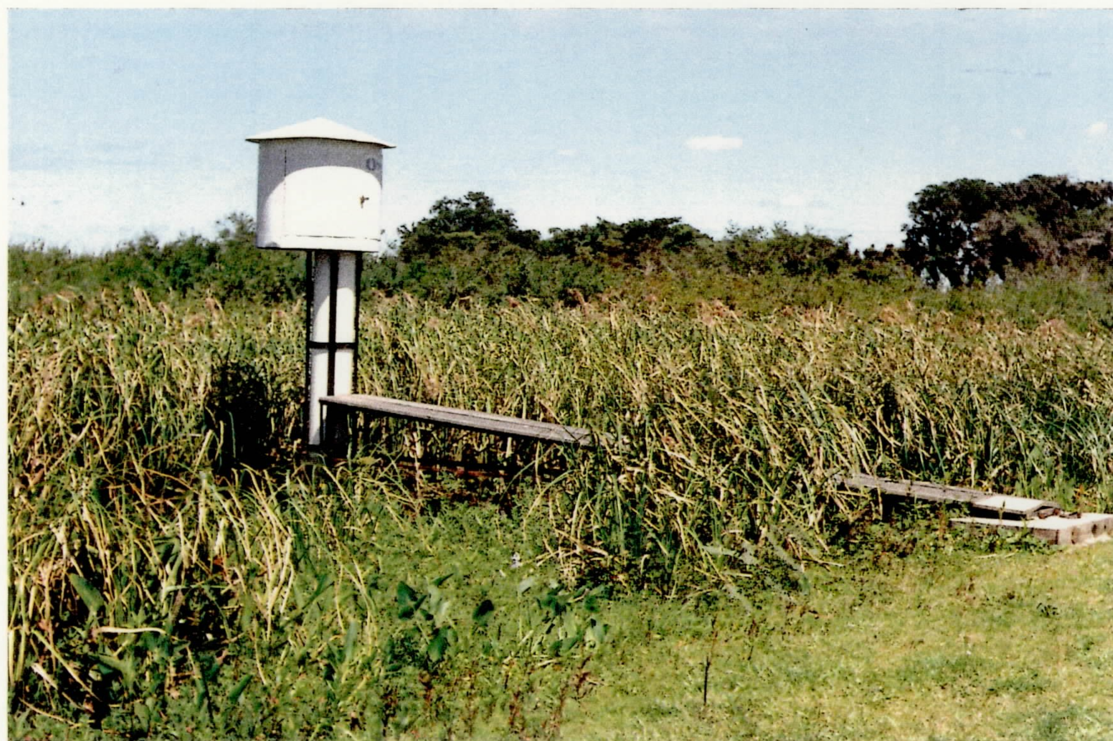
Foto 10 - Estação linigráfica de Banhado Grande.
