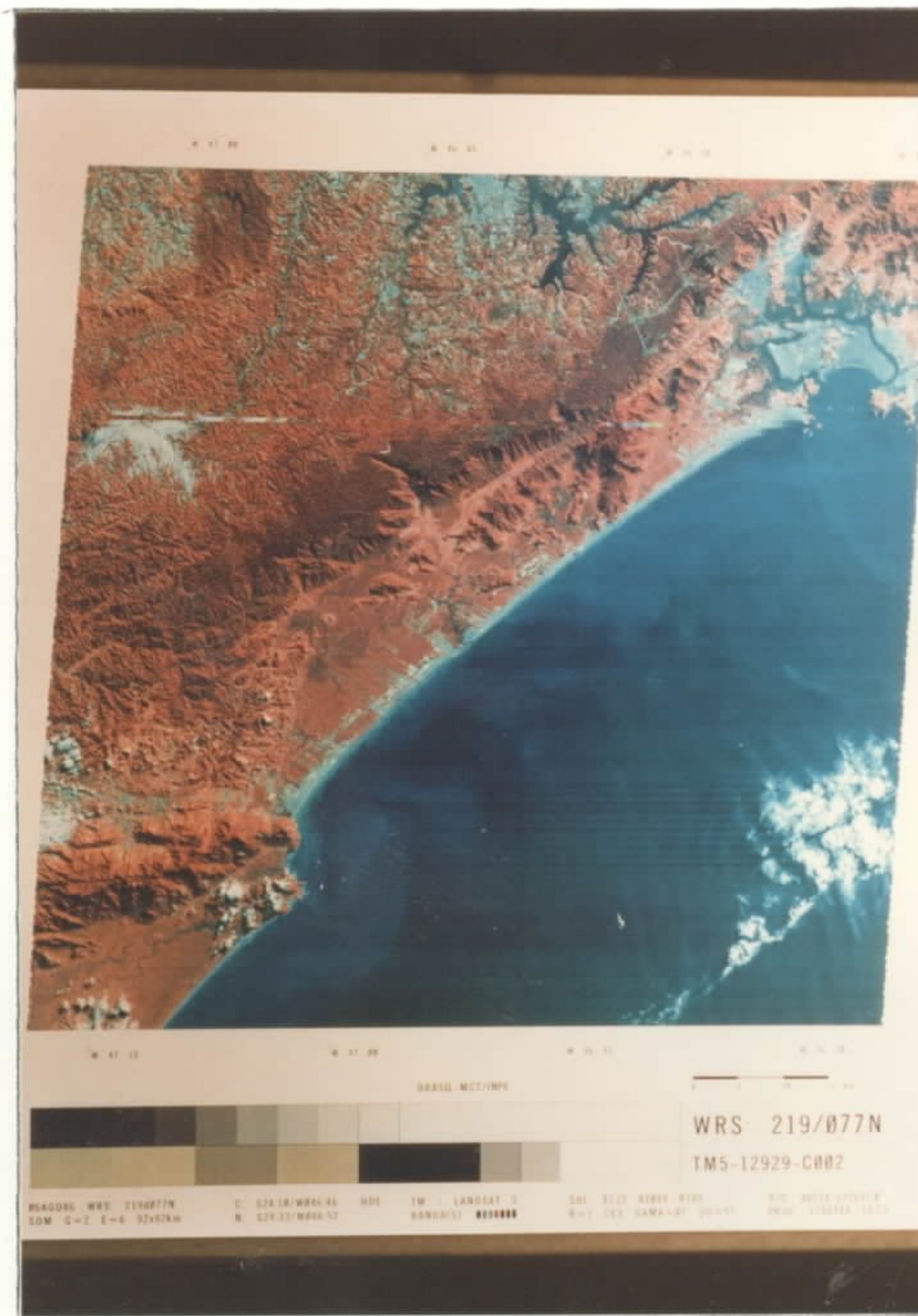
Foto 20 - Imagens do Satélite TM LANDSAT 5, composição colorida das bandas 2,3 e 4; realçando as cores: azul para água, vermelho para cobertura vegetal e branco para o solo exposto e/ou ocupado por urbanização. Região São Vicente-Peruíbe.
