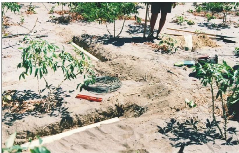
Foto 2. Disposição das bobinas de indução, segundo direções ortogonais X e Y (norte magnético e leste), utilizadas para medir as variações temporais do campo geomagnético, no levantamento geofísico, com o Método Magnetotelúrico - MT (apud Correia Filho, 2009).
