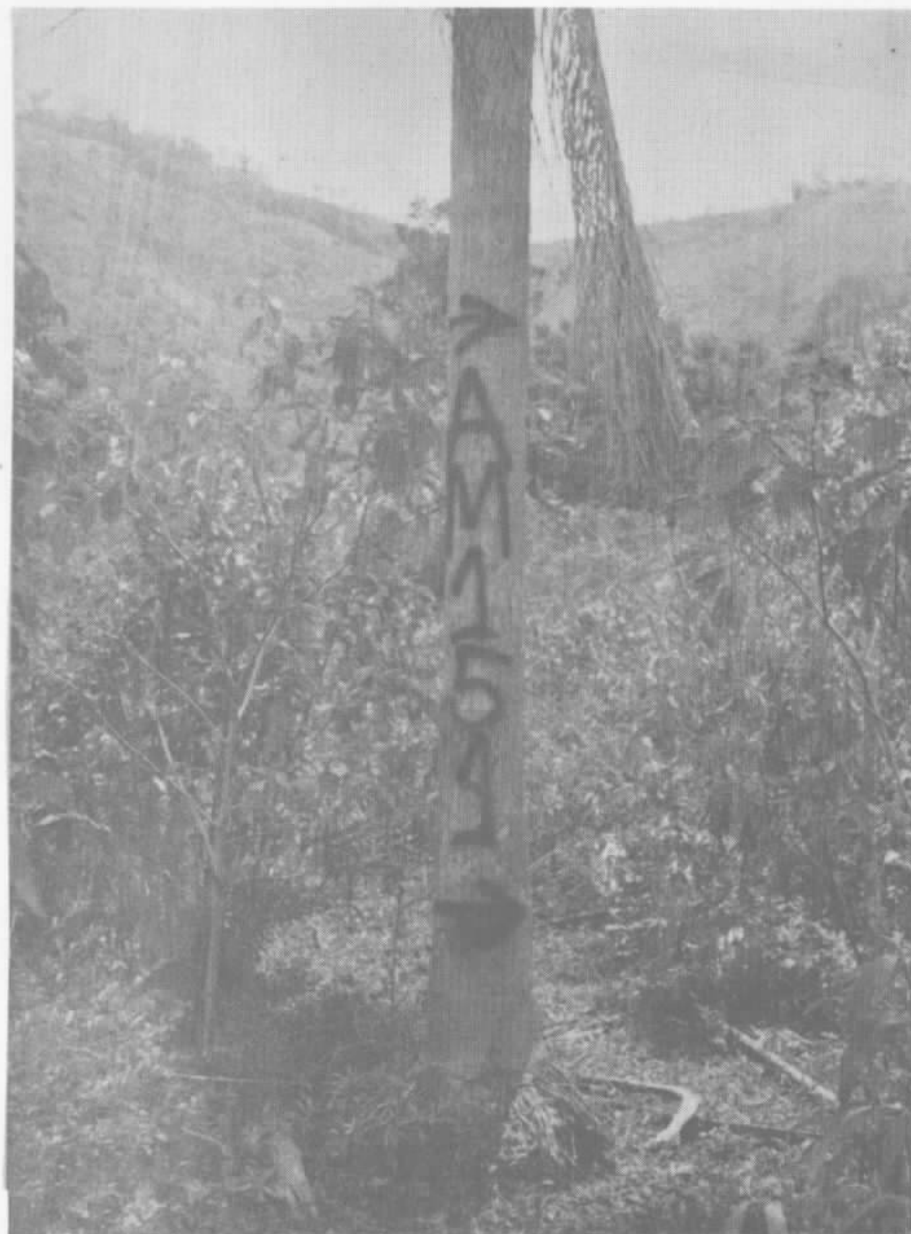
Foto nº 38 - Sequência de amostragem: locação da amostra no campo através da sigla do técnico e o número correspondente da amostra.
