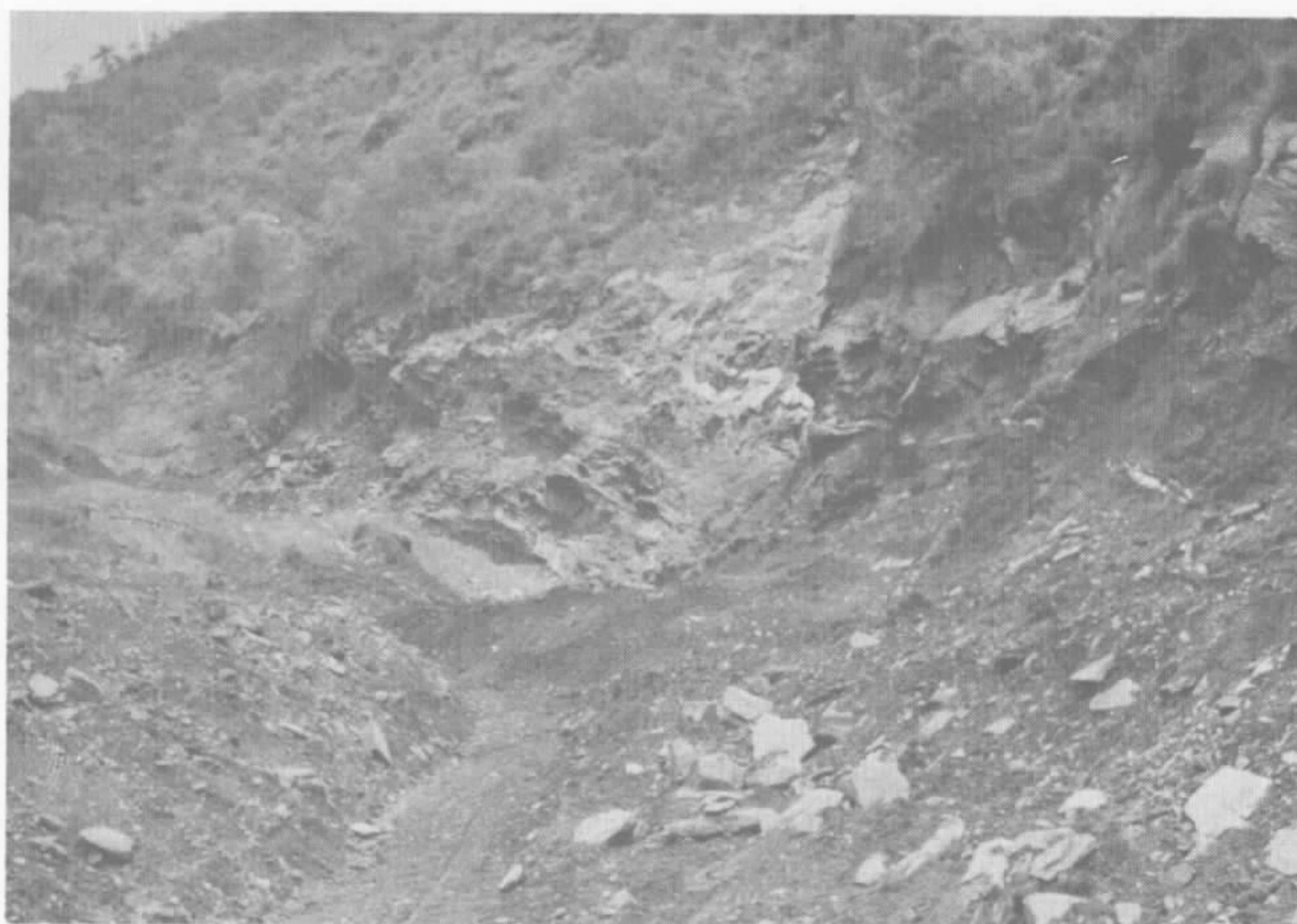
Foto nº 29 - Aspecto da frente de lavra realizada na mina do Perau. Notar a estruturação das camadas onde se encontra encaixada a zona mineralizada.
