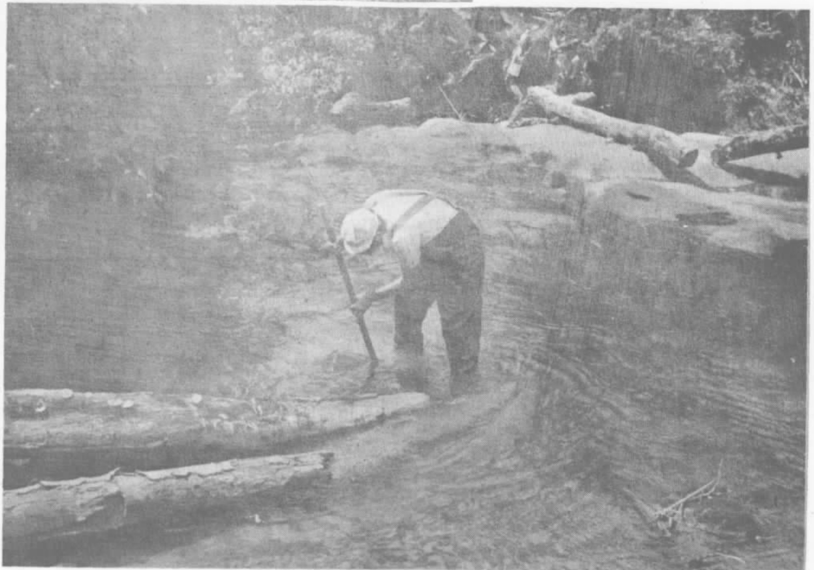
Foto nº 34 - Sequência da amostragem: coleta do sedimento de corrente com a utilização de uma pá comum.
