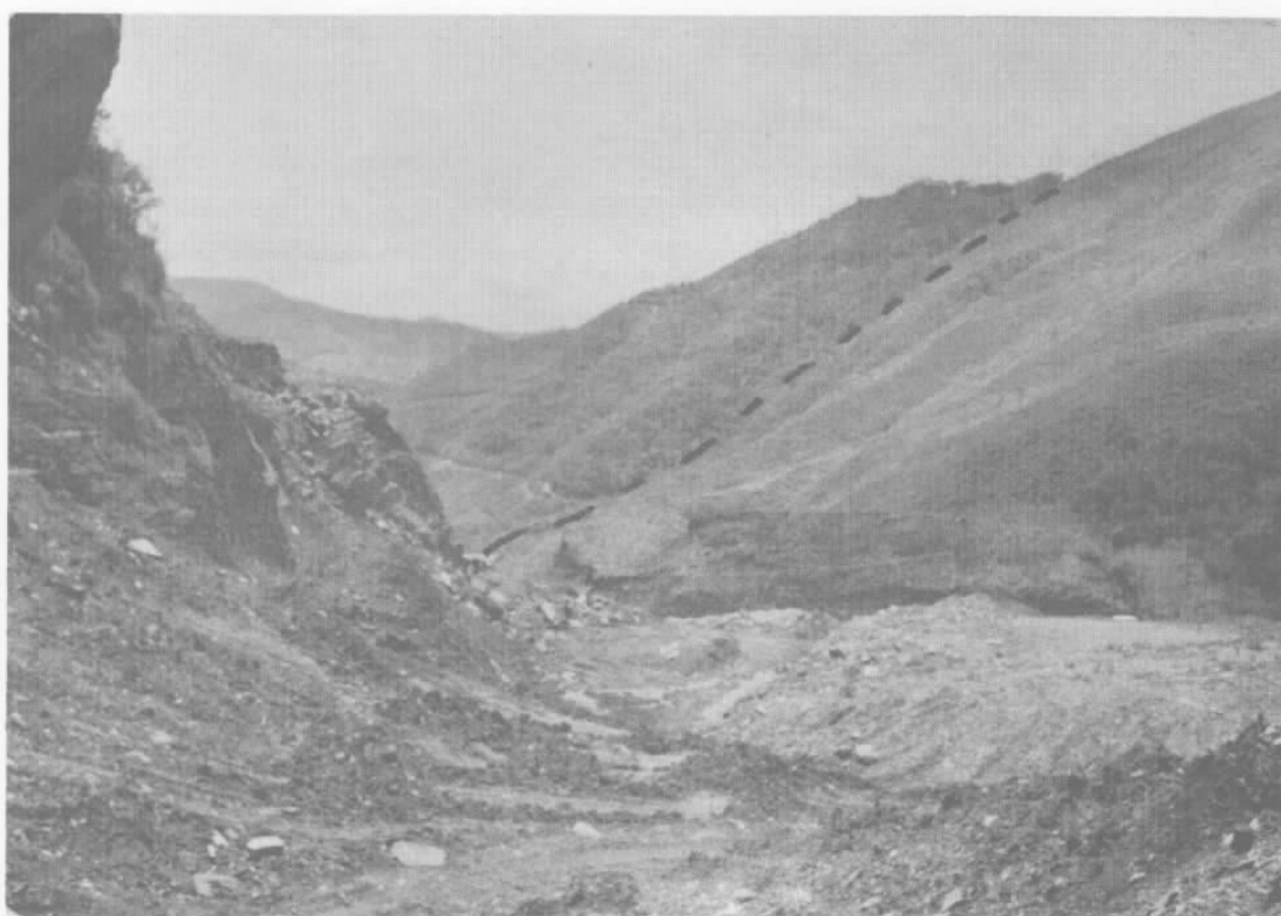
Foto nº 30 - Em primeiro plano observa-se a frente de lavra da mina do Perau. Em segundo plano, con tato entre o pacote de quartzito e a continuidade da zona mineralizada.
