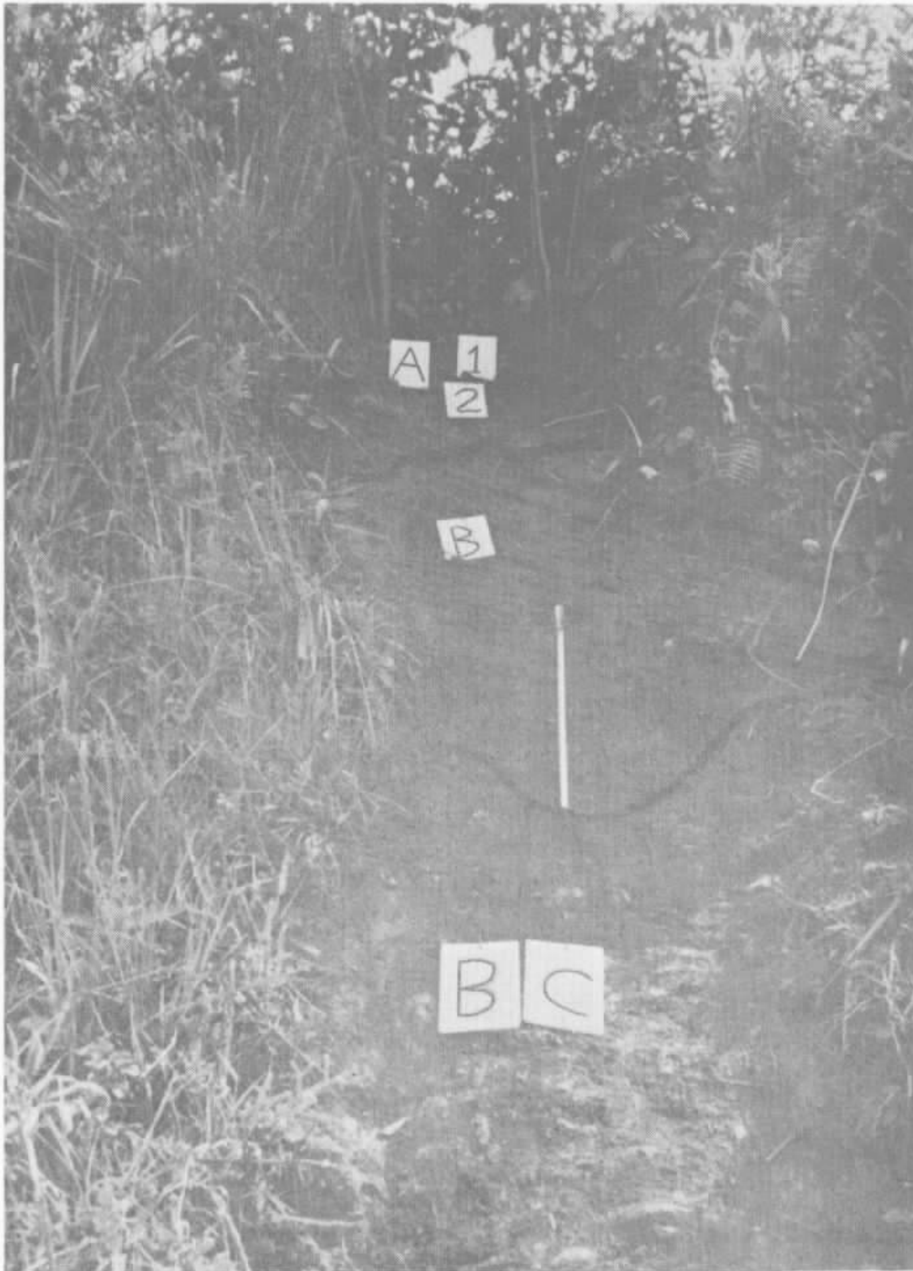
Foto nº 19 - Perfil parcial de solo do tipo podzólico vermelho-amarelo desenvolvido sobre metassedimentos síltico argilosos, onde estão destacadas a separação dos horizontes. Estrada Apiaí-Iporanga.
