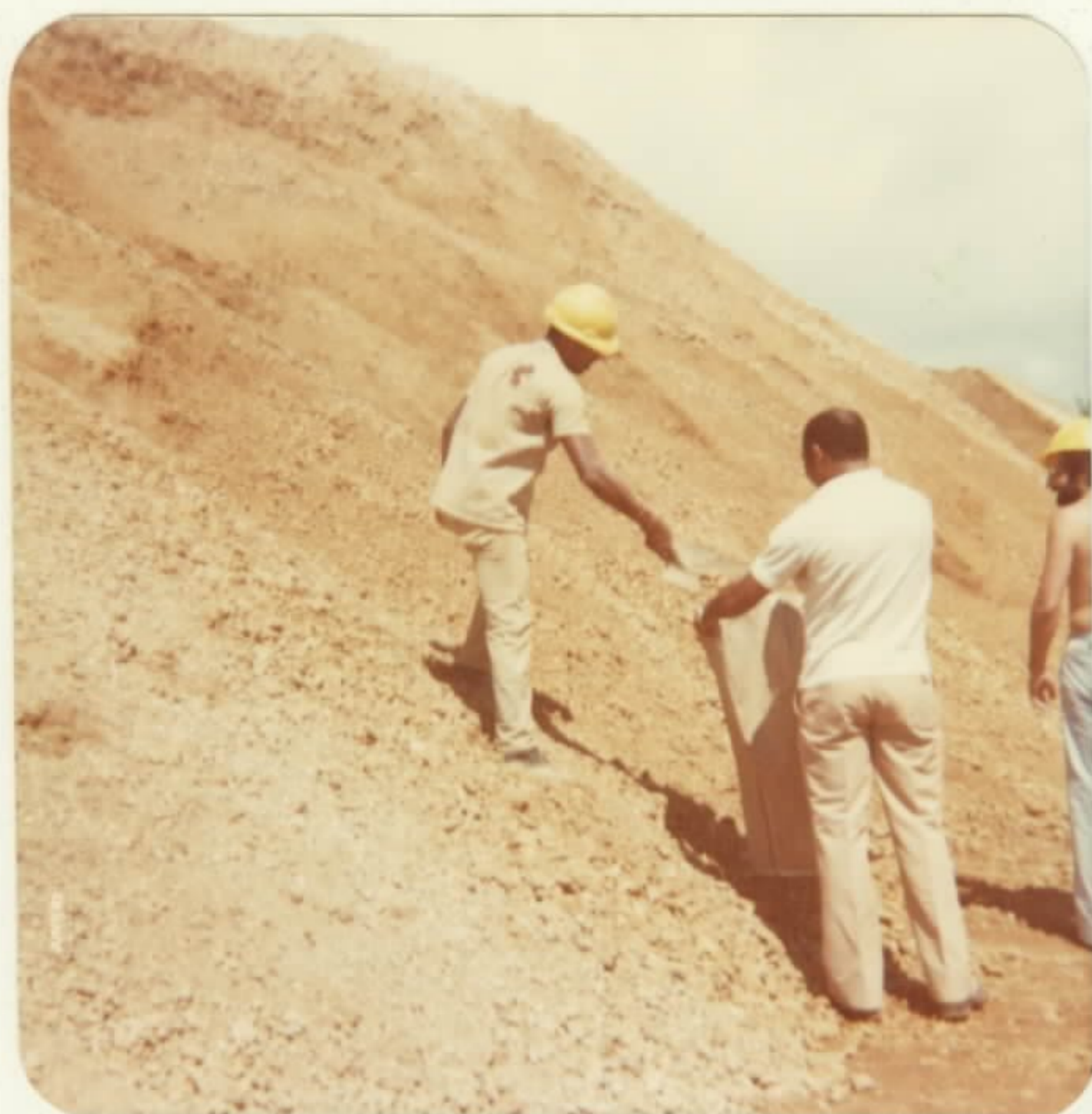
Figura 7 - Retirada de Amostras na Pilha de Concentrado - Baroid
