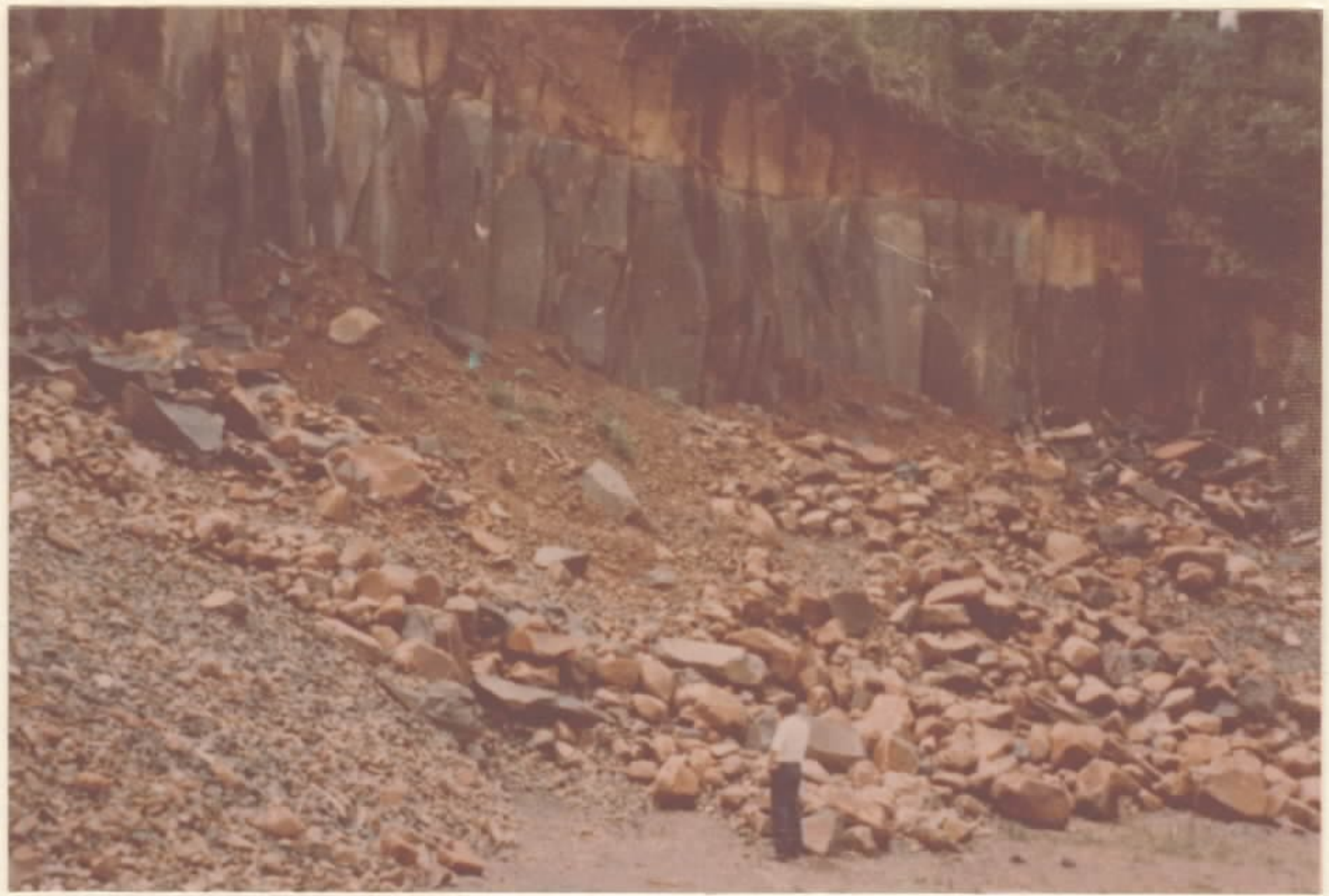
Foto 1 - Zona intermediária, com fraturamento vertical, de derrame basáltico típico, com cobre nativo em fraturas e disseminado no seio da rocha. Pedreira da Prefeitura de Itapiranga. Macaco Branco.
