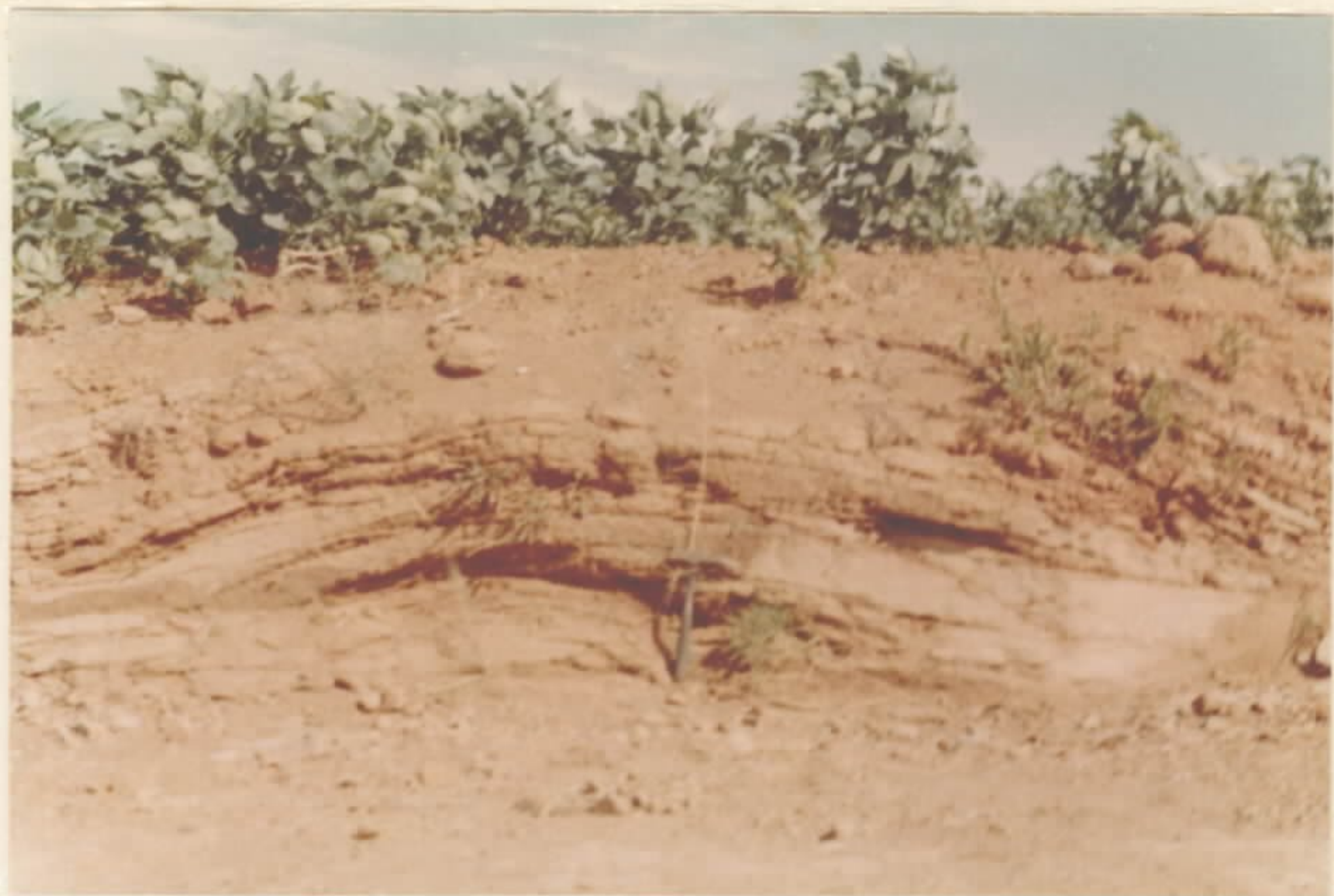
Foto 27 - Solo tipo A/C , muito delgado , formado de fragm. de basalto intemperizado com "línguas" de material argiloso. Predomina na área de estudo. Nesta foto desenvolvido sobre zona "dobrada" de diaclasamento horizontal. Esquina Colorada. Tenente Portela.
