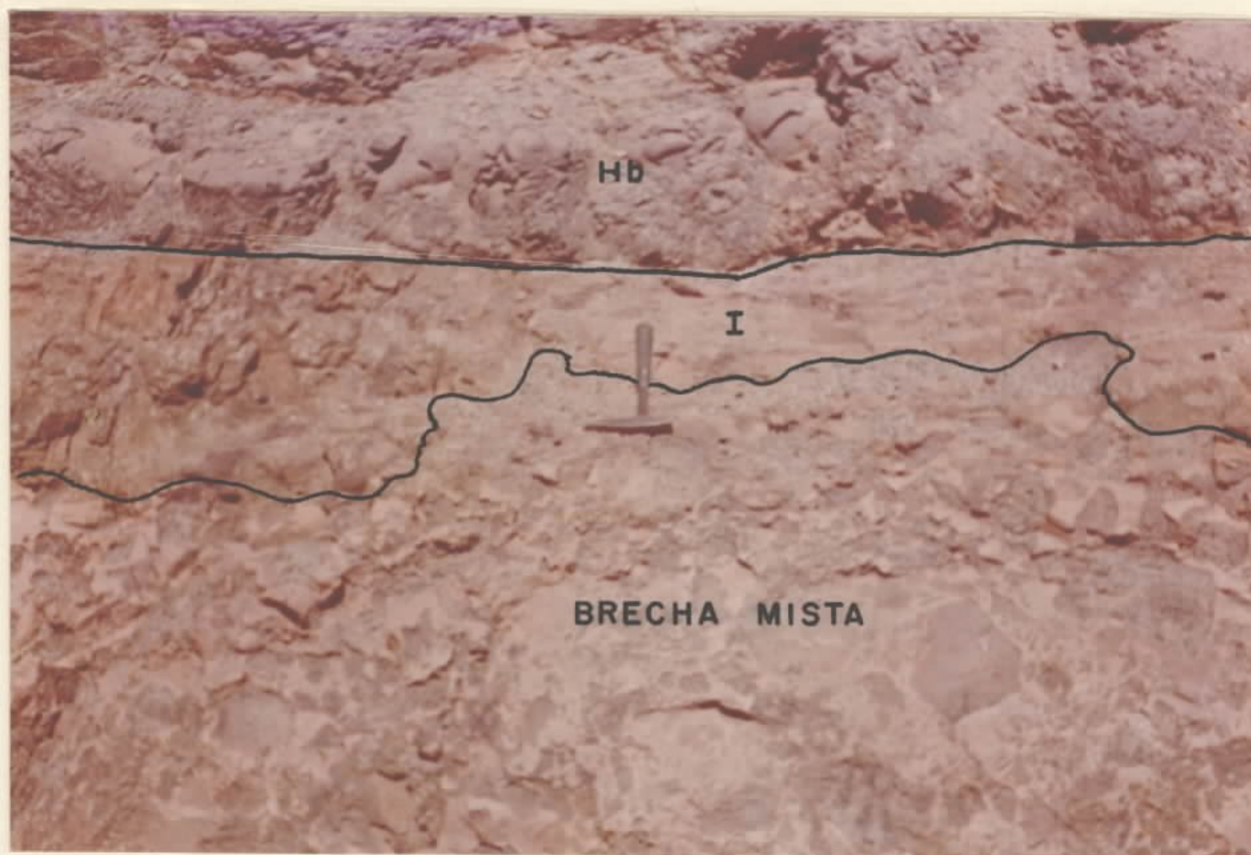
Foto 17 - Brecha mista (basalto + arenito) separada da base do derrame superior (Hb) por um nível de arenito intertrápico (I), evidência definitiva da ligação da brecha com o derrame inferior. Km 420, BR-386.
