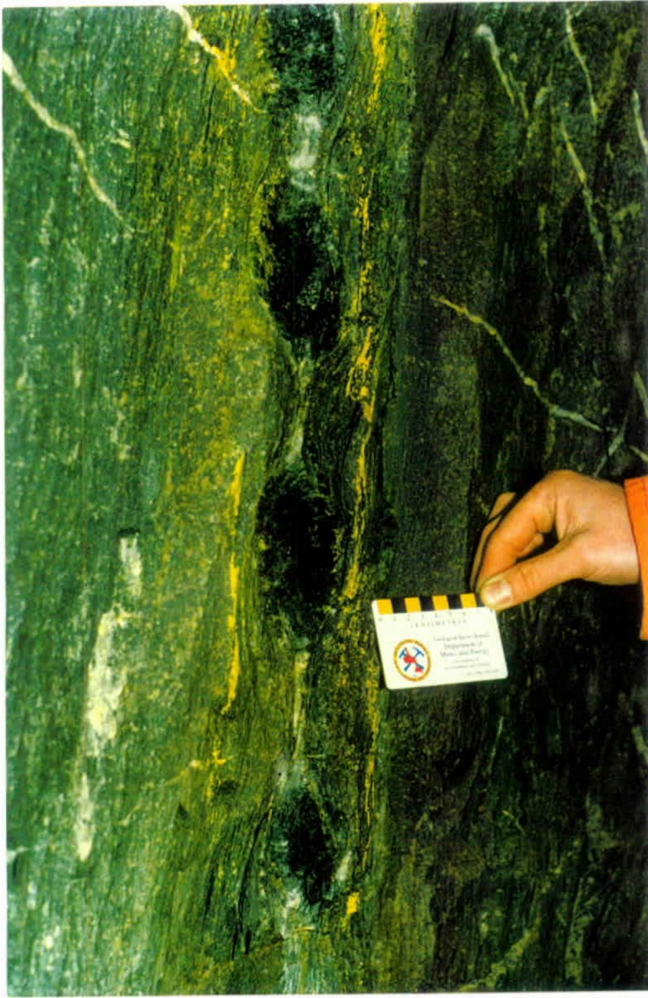
Figura 5 - Veios de quartzos bu- dinados concordantes com a foli- ação e veios de quartzo-carbo- nato oblíquos, encaixados em domo dacítico, com sulfetos e ou- ro disseminados.
