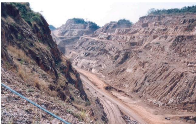
Figura 4.3 - Vista da cava da mina de zinco da Votorantim em Vazante, MG. O minério é tipo óxido em zona de falha, como mostrada no alinhamento NE da Foto 3.17. Foto cedida pelo geólogo Júlio M.M. Pinho (SGB-CPRM).
