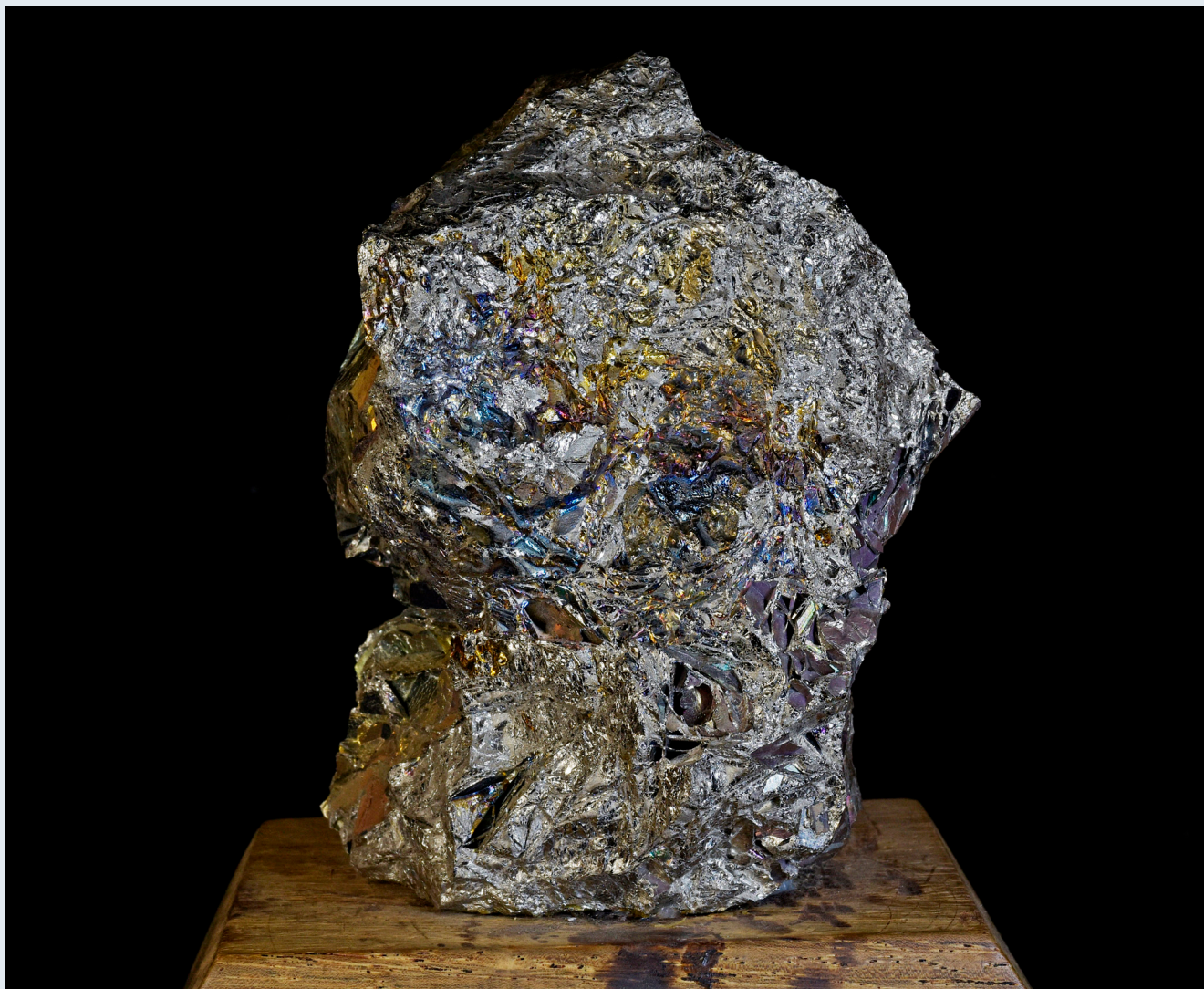
Liga de ferro nióbio produzida em Araxá, MG Aproximadamente 20 cm de altura
