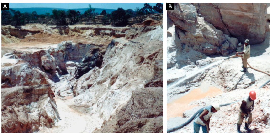
Figura 8.11 - Fotos (A e B) da lavra de quartzo em veio por desmonte hidráulico na Serra do Cabral. Localidade Comexa, Francisco Dumond. Fotos: Arlindo Yamato.
