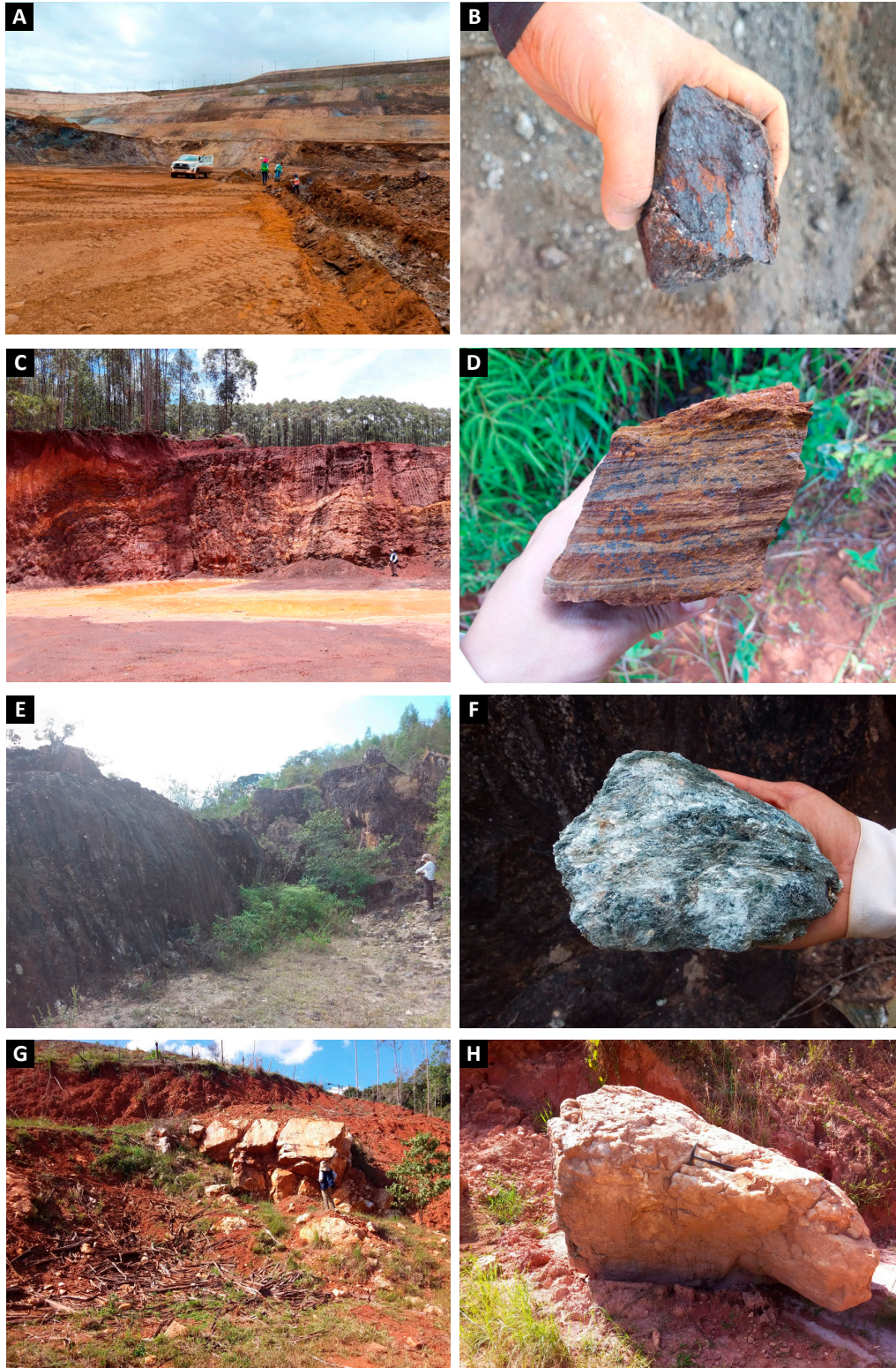
Figura 5.2 - Recursos Minerais das folhas Florália e São Gonçalo do Rio Abaixo A) Extração de minério de ferro na Mina de Brucutu, em cava a céu aberto; B) Amostra de mão de itabirito da Mina de Brucutu. C) Cascalheira Florália, destinada à extração de cascalho (afloramento MS-114); D) Amostra de mão de formação ferrífera bandada da Cascalheira do Geraldo (afloramento RC-037); E) Lavra abandonada de esteatito (afloramento RC-145), destinada à extração de “pedra-sabão”; F) Amostra de mão de esteatito, comumente utilizado na confecção de painéis e outras peças artesanais; G) Lavra paralizada de quartzo (afloramento RC-039), com extração voltada para uso industrial e/ou ornamental; H) Bloco de quartzo cristalino a leitoso, presente na entrada da lavra. Fonte: Fotos do arquivo do próprio projeto e Imagens A e B cedidas pela Vale S.A.
