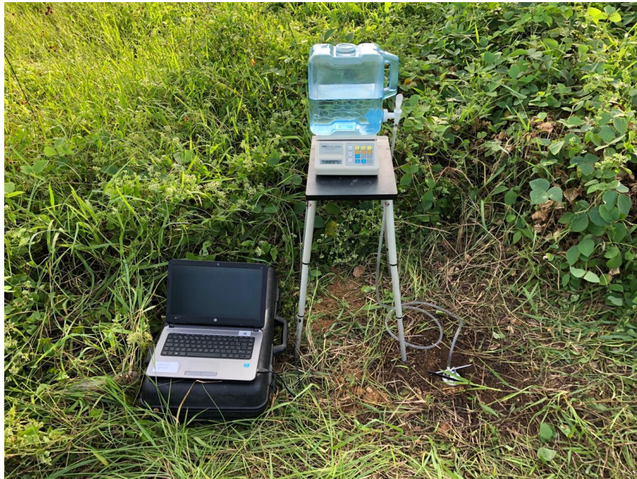
Figura 6 - Ensaio de permeabilidade, com carga constante, realizado com Permeômetro Aardvark.
