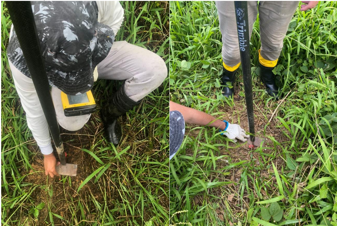
Figura 10 - Leitura das coordenadas e sua altitude em relação ao Datum Vertical: Marégrafo de Imbituda – SC, com RTK.
