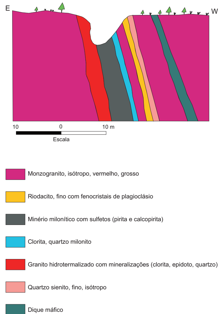
Figura 4.3 – Perfil esquemático da cava principal do garimpo do Edu.
