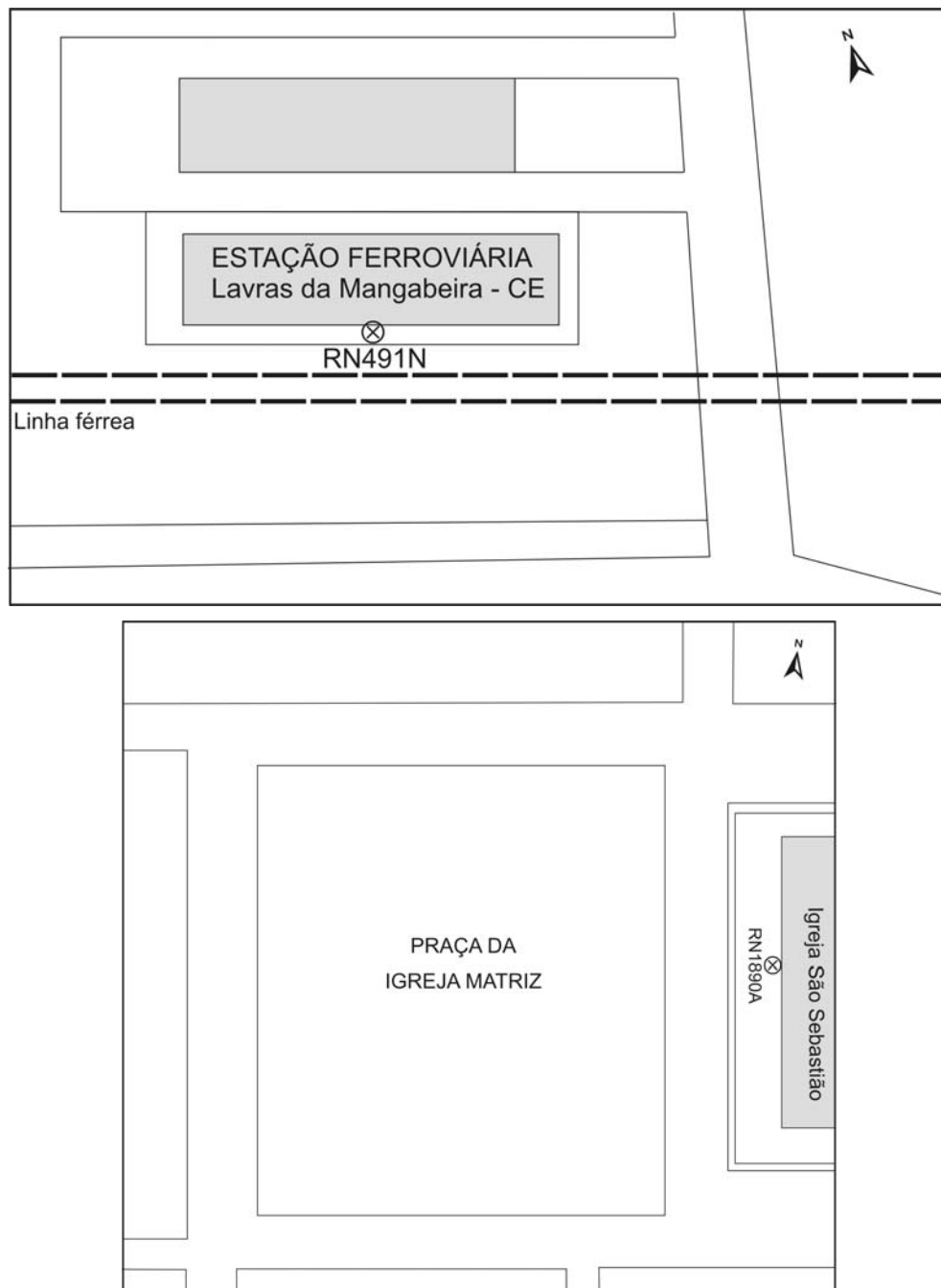
Fig. 5. Esboços esquemáticos das estações base do levantamento gravimétrico em Lavras da Mangabeira (RN491N) e Mangabeira (RN1890A). Ver descritivo das RRNN's na Tabela 1.
