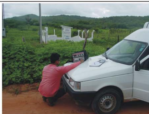
Estação 01 do Perfil de Resistividade (GH), bacia Riacho do Meio. Como visto na fotografia, esta estação foi realizada próxima a um poço profundo produtor.
