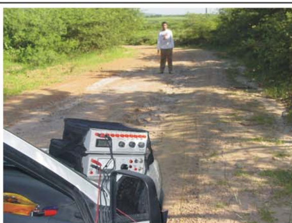
Detalhe da aquisição dos dados ao longo do Perfil de Resistividade (AB). O equipamento utilizado corresponde a um VT-250 (transmissor) e VR-250 (receptor).
