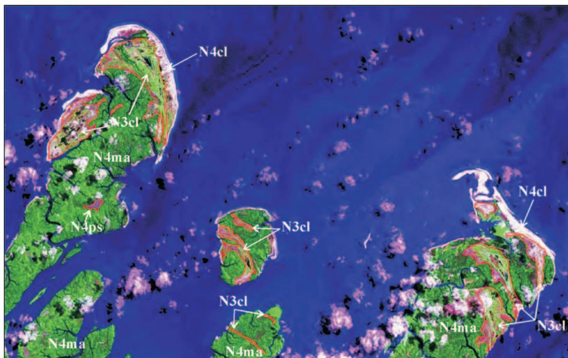
Figura 3.21 - Disposição das unidades morfo-estratigráficas individualizadas em imagem Geocover 2000: Depósitos de cordões litorâneos antigos (N3cl). Depósitos de mangue e aluvionar (N4ma). depósitos de cordões litorâneos (N4cl) e depósitos de pântanos salinos (N4ps).
