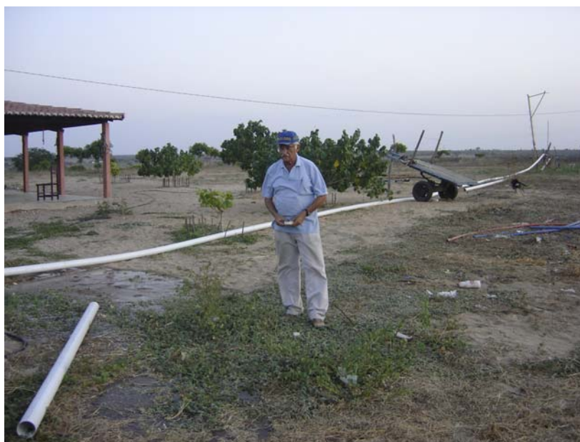
Figura 4.9 - Tubos de PVC usados como recptador e condutor da água que sai do tubo escoador de orifício circular, evitando-se, assim, o acúmulo e infiltração de água no local do teste (Arq. DSC0028)
