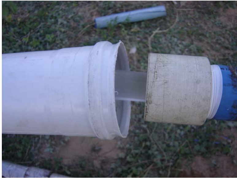
Figura 4.10 - Descarga efetuada diretamente do tubo nos tubos de PVC para evitar acúmulo e infiltração de água no local do teste (Arq.DSC030)
