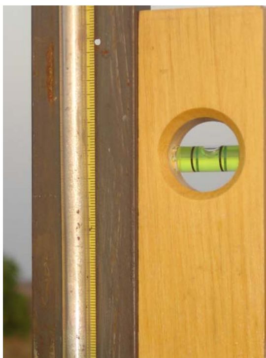
Figura 4.7 - Nivelamento da coluna suporte vertical em detalhe (Arq. DSC 0013)
