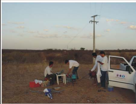
Sondagem Elétrica Vertical 04, realizada sobre os arenitos da Formação Geológica Açú.
