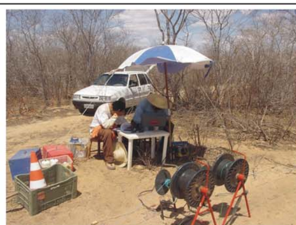
Detalhe da aquisição dos dados de resistividade aparente correspondente a SEV 09.
