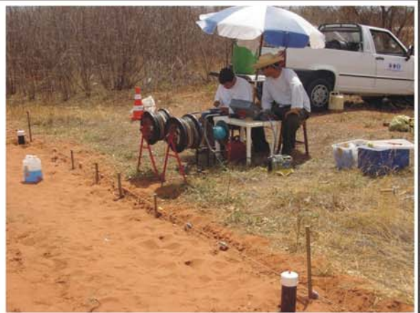
Detalhe do centro da Sondagem Elétrica Vertical 01, com linha AB de 2000 metros. Equipamento utilizado corresponde a um Eletroresistivímetro PER-500, fabricado pela DPM engenharia.
