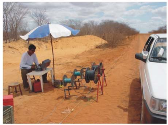
Detalhe do centro da Sondagem Elétrica Vertical 10 (Bacia Potiguar). Realizada sobre os calcários da Formação Jandaira.
