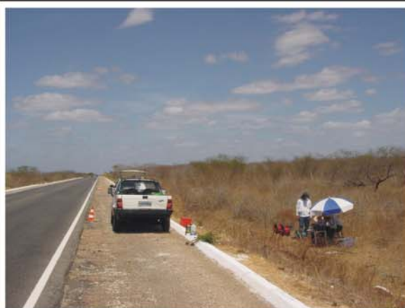
Sondagem Elétrica Vertical 03, realizada também na rodovia federal BR-304.
