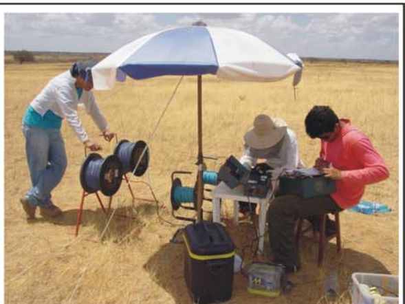
Detalhe da aquisição dos dados de resistividade aparente correspondente a SEV 06.
