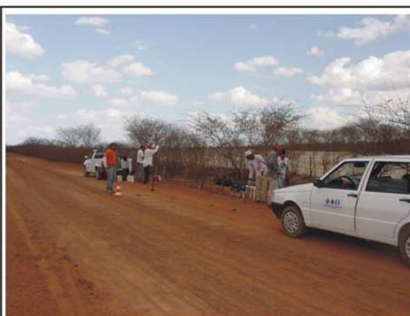
Sondagem Elétrica Vertical 08. Fotografia exibindo a introdução dos eletrodos no solo.
