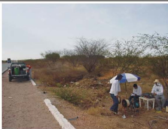
Sondagem Elétrica Vertical 02, realizada na BR-304 entre as sedes municipais de Mossoró e Açú - RN (Bacia Potiguar).
