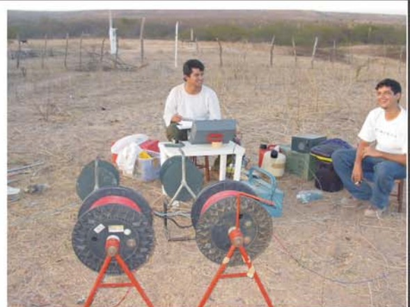
Detalhe do centro da Sondagem Elétrica Vertical 04, com linha AB de 2000 metros.
