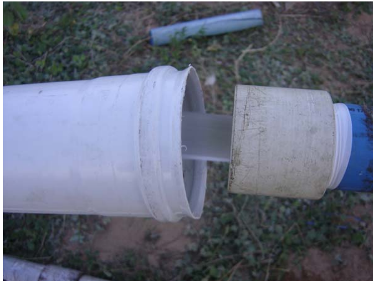
Figura 10 - Descarga efetuada diretamente do tubo nos tubos de PVC para evitar acúmulo e infiltração de água no local do teste (Arq.DSC030)
