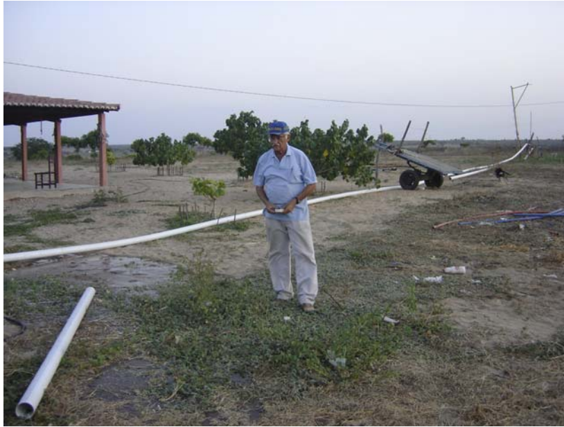
Figura 9 - Tubos de PVC usados como recptador e condutor da água que sai do tubo escoador de orificio circular, evitando-se, assim, o acúmulo e infiltração de água no local do teste (Arq. DSC0028)
