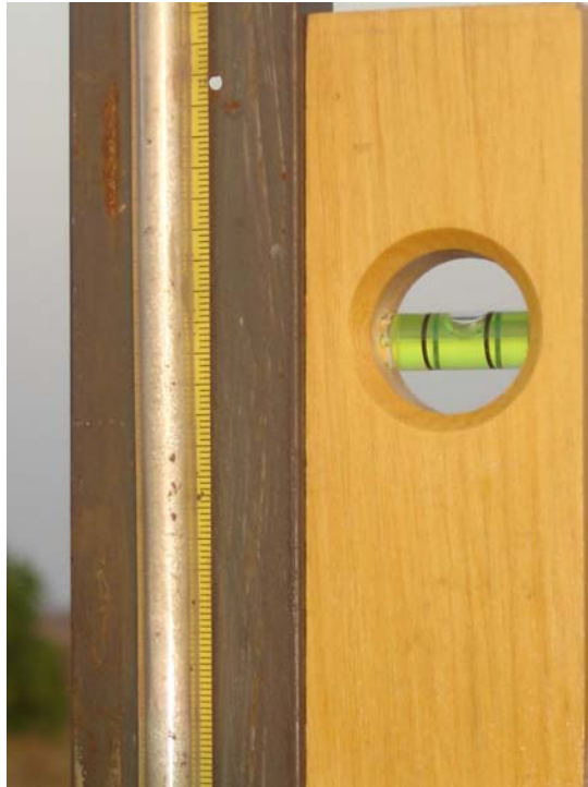
Figura 7 - Nivelamento da coluna suporte vertical em detalhe (Arq. DSC 0013)
