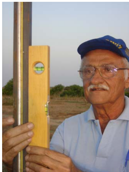
Figura 6 - Nivelando coluna suporte vertical contendo mangueira e a escala métrica usada para medição da carga hidráulica (Arq. DSC0012)
