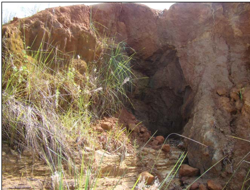
Figura V.5.78 – Afloramento com ocorrência de erosão por piping (dimensões: 1,5 m largura / 2 m altura).
