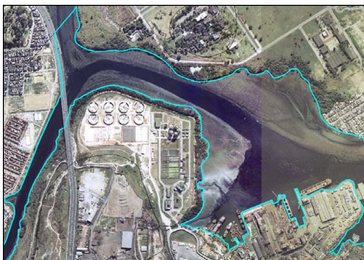
Figura V.5.1 – Vista geral da área de deposição de argilas moles sobre mar raso.
