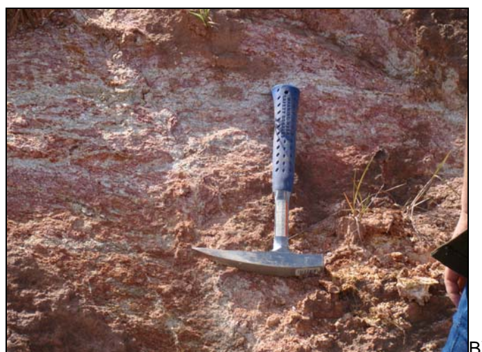
Figura V.5.73 A – Afloramento dos horizontes de solo residual raso e saprólito da Ug_Sap_gn_mig. B) Detalhe do horizonte de saprólito.
