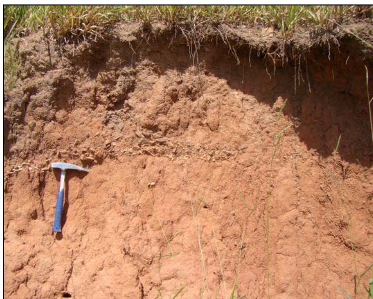
Figura V.5.14 – Camada de colúvio recobrimdo solo residual. Nota-se a presença de linhas de pedras marcando o limite entre as duas unidades geotécnicas.
