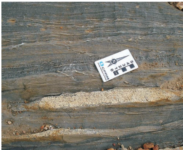
Figura 84 - Intercalações de clorita gnaissé com granada (cor branca) paralelos a foliação principal do micaxisto (ou filito).
