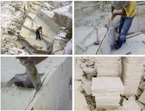
Figura 55 e 56 - Área de extração e distribuição de rejeito e detalhes do processo de extração de quartzito.
