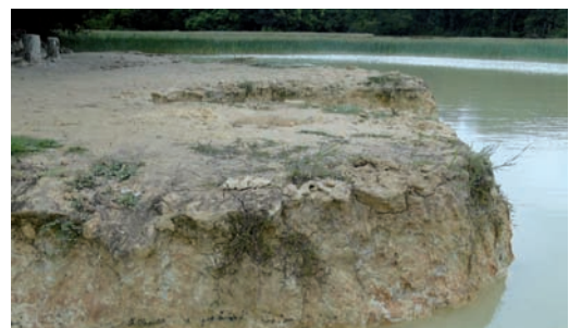
Figura 12 - Detalhe da rocha argilosa de cor branca a creme. Frações de silte também ocorrem.
