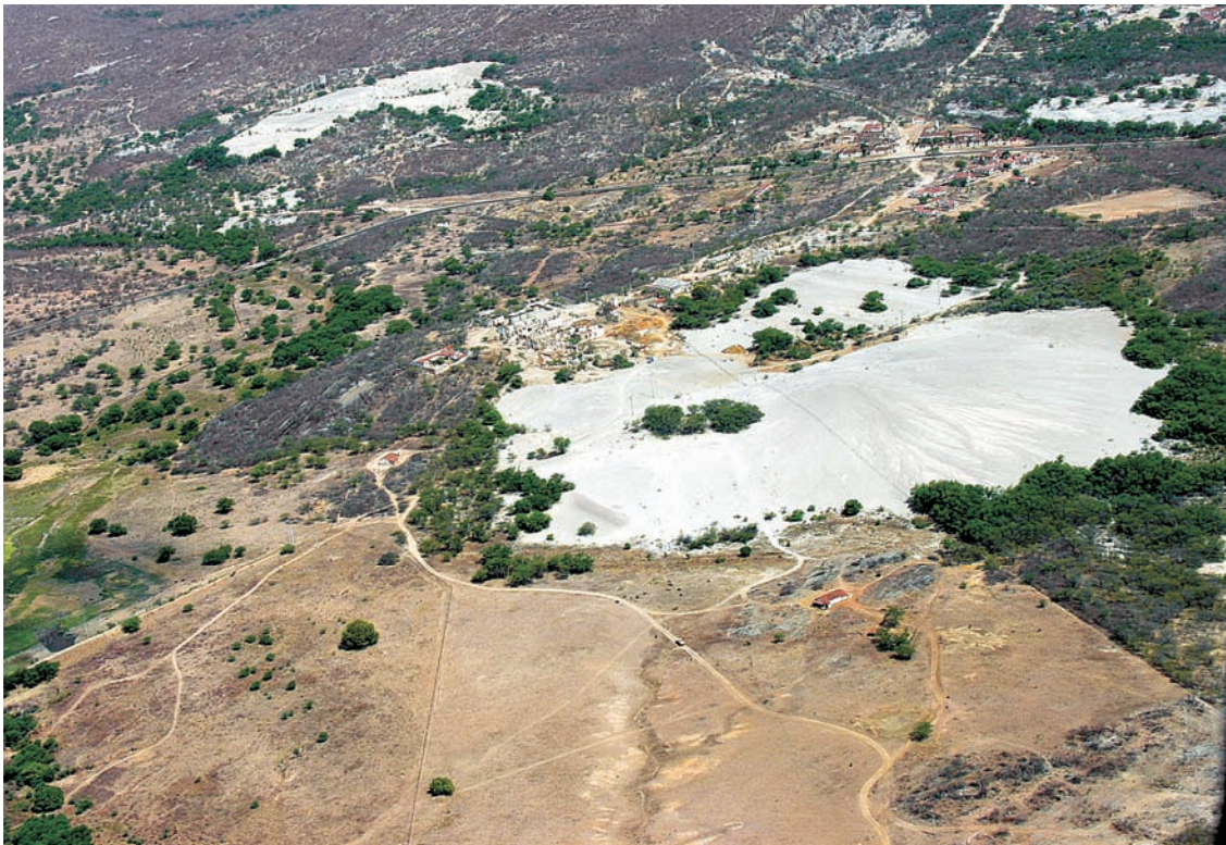
Figura 49 - Vista aérea do Parque Temático da Mina Brejuí e o depósito de acúmulo de rejeitos da mina (em primeiro plano). Foto: R. Diniz.
