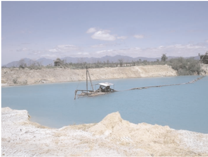
Figura 4 – Drega em funcionamento em uma das cavas.
