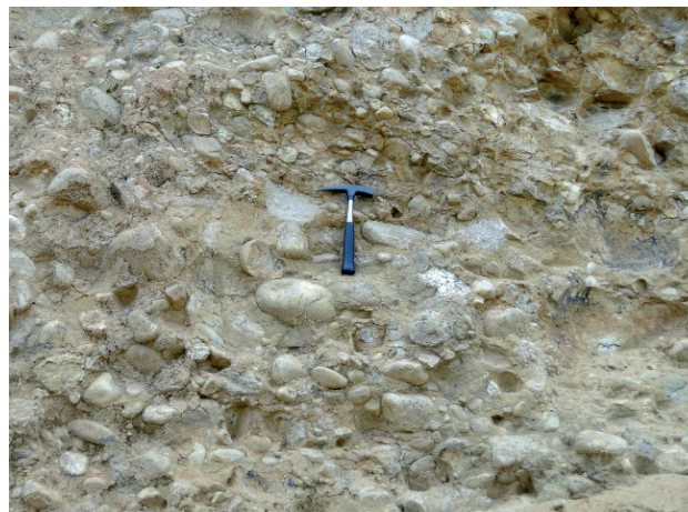
Figura 6.46 - Conglomerado polimítico da Formação Poção, com clastos de quartzo e granito que variam de seixos a matacões, padrão textural impactante na execução de obras de engenharia (AL). Fotografia: Violeta de Souza Martins (2011).
