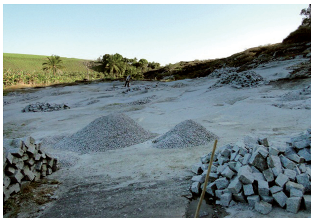
Figura 6.80 - Pedreira Xavier voltada para extração de paralelepípedos, rachão e brita. Município de Matriz de Camaragibe-AL. Fotografia: Violeta de Souza Martins (2011).
