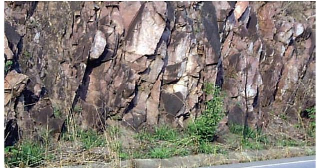
**Figura 3.55:** Afloramento de rocha intensamente fraturada em corte de estrada (favorabilidade a desprendimento de blocos).
