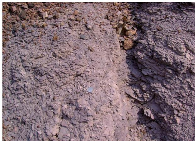
**Figura 4.82** - Talude de corte na unidade DSVMPSaa (predomínio de sedimentos siltico-argilosos com intercalações arenosas), nesse caso, são folhelhos da formação Ponta Grossa exibindo denso fraturamento conchoidal (Pedro Gomes, MS).
