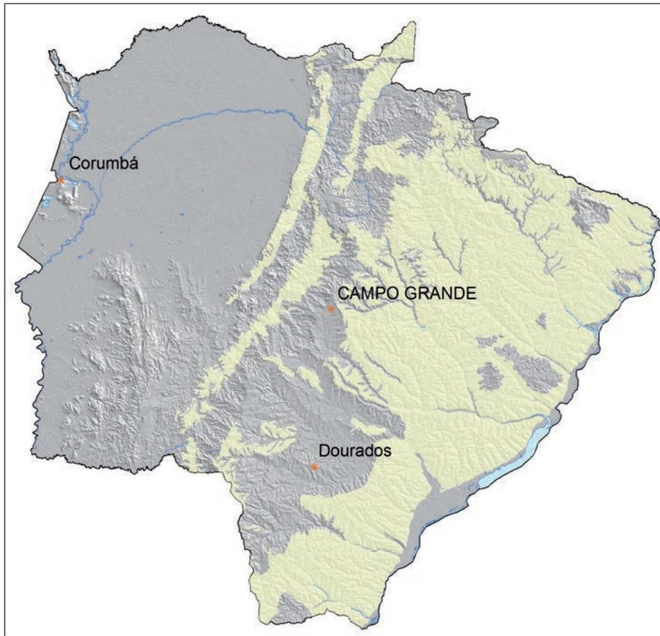
**Figura 5.6** - Terrenos sustentados por sedimentos e solos arenosos, com relevo suave ondulado a aplainado.
