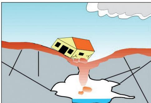
**Figura 4.36** - Ilustração do que pode ocorrer com construções sobre terrenos sujeitos a colapso.
