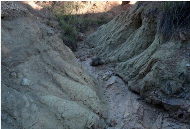
**Figura 4.196** - Imenso foco erosivo na margem da rodovia BR-276, induzido pela retirada do solo superficial (Porto Murtinho, MS).
