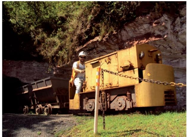
Figura 4.183 - Vagão utilizado para retirada do minério do interior da mina dos Belgas (Corumbá, MS).
