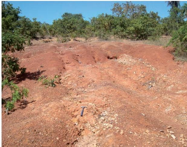
**Figura 4.154** - Processo erosivo induzido pela exposição de solo pouco evoluído oriundo de quartzo-xistos do grupo Cuiabá (unidade DSP2sag), exibindo feições de empastilhamento, o que sugere a presença de argilominerais expansivos (Aquidauana, MS)
