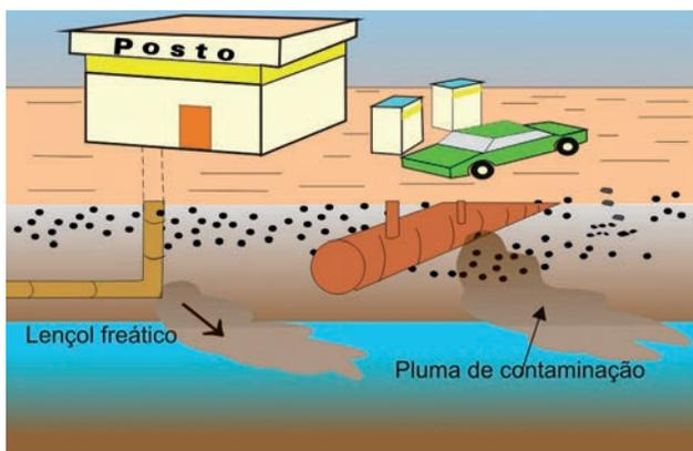
**Figura 4.6** - Vazamento de poluente em áreas onde o lençol freático situa-se próximo à superfície.
