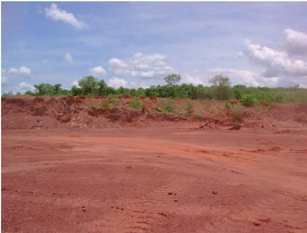
**Figura 4.87** - Frente de lava da Mineração Volpini Indústria Cerâmica Ltda., que explora argilas da unidade DSVMPasaf, nesse caso, representada pelos sedimentos da formação Aquidauana (Dois Irmãos de Buriti, MS).
