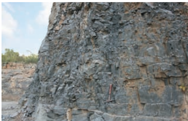
Figura 11.17 – Lavra de calcário calcítico para fabricação de brita; calcário horizontalizado bastante fraturado, com intercalações argilosas (o calcário tem menos de 5% de MgO) (formação Nova Olinda).
