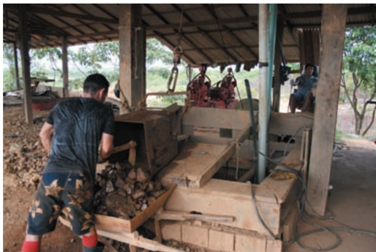
Figura 11.26 – Vista de um shaft para retirada de material rochoso, essencialmente de veios de quartzo para produção de ouro primário (formação Chega Tudo).
