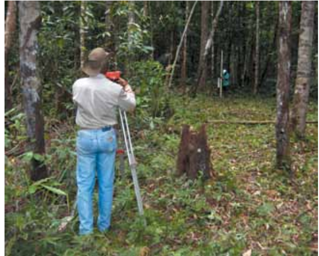
Figura 5.17 - Nivelamento Topográfico para Levantamento de Seção Transversal.
