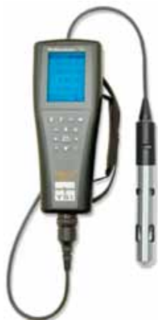
Figura 5.16 - Sonda portátil de Qualidade da Água.
