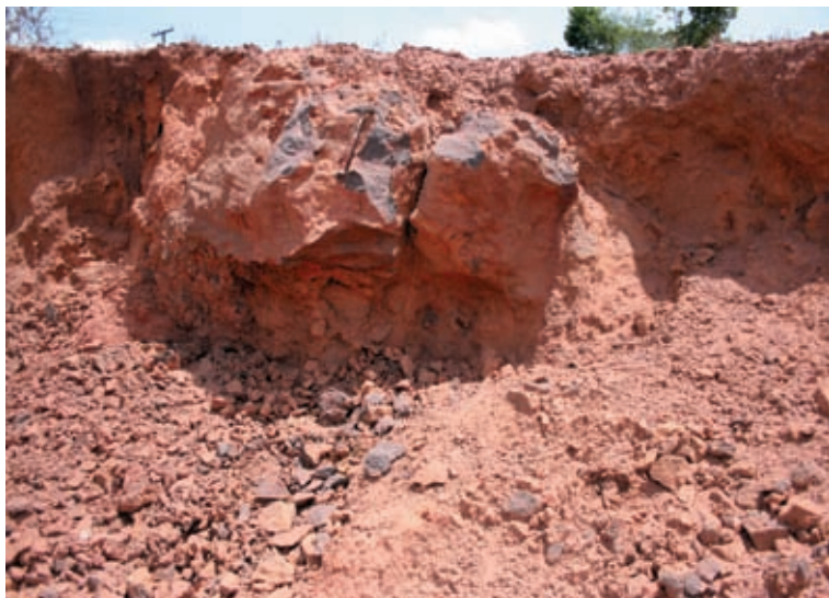
Figura 11.7 – Espessa crosta laterítica ferruginosa com formação in situ , extraída para utilização imediata na construção civil.
