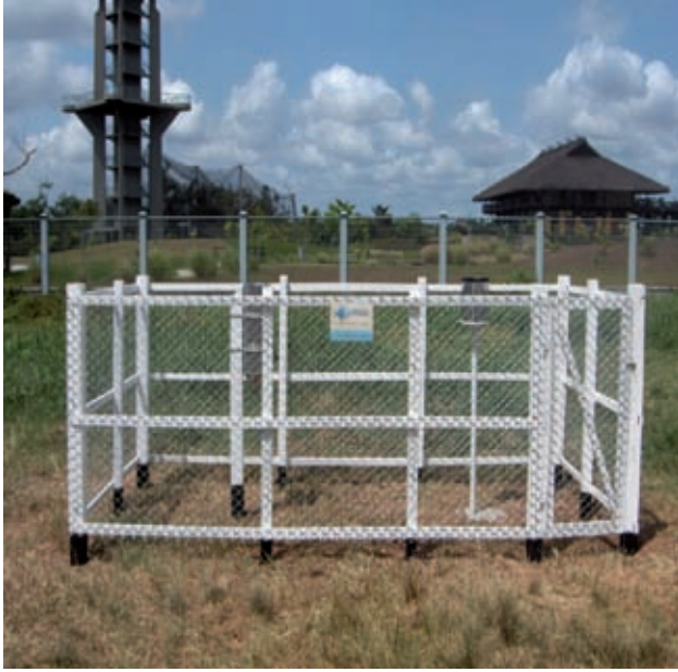
Figura 5.4 - Estação Pluviográfica em Belém - 4º Distrito Naval.
