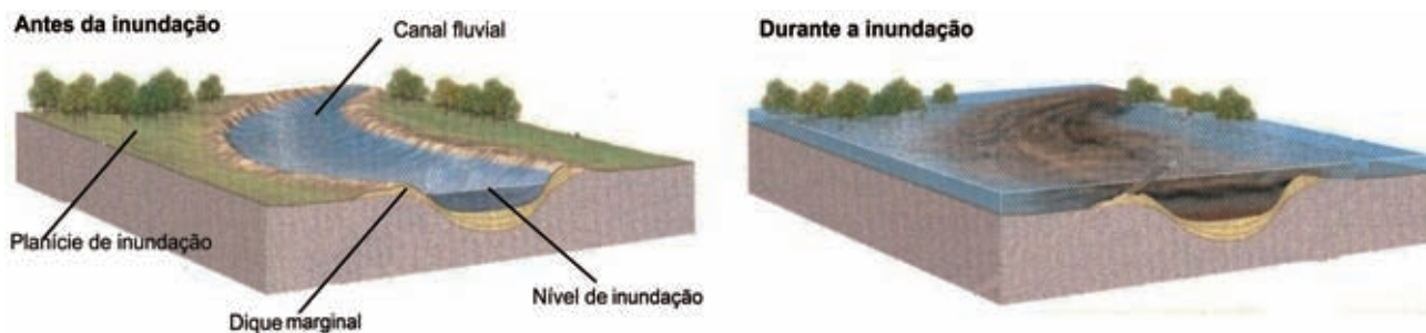
Figura 8.4 – Ilustração do processo de inundação de um rio. Fonte: Modificado de Press et al. (2006).
