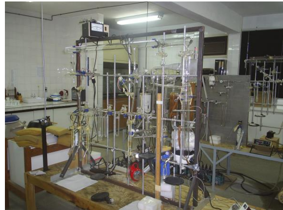
Figura 2.2a) Amostra de cimento carbonático em vácuo a uma temperatura de 25°C; (b) Linha de extração de carbonato; (c) espectrômetro de massa SIRA II da VG ISOTECH do LABISE-UFPE.
