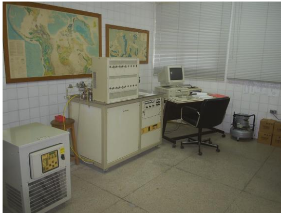
Figura 2.2a) Amostra de cimento carbonático em vácuo a uma temperatura de 25°C; (b) Linha de extração de carbonato; (c) espectrômetro de massa SIRA II da VG ISOTECH do LABISE-UFPE.
