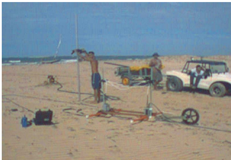
Figura 2.1. Montagem dos equipamentos GPR e testemunhador vibracore nas imediações do afloramento B2 próximo ao rio Curú na região de Lagoinha-CE.
