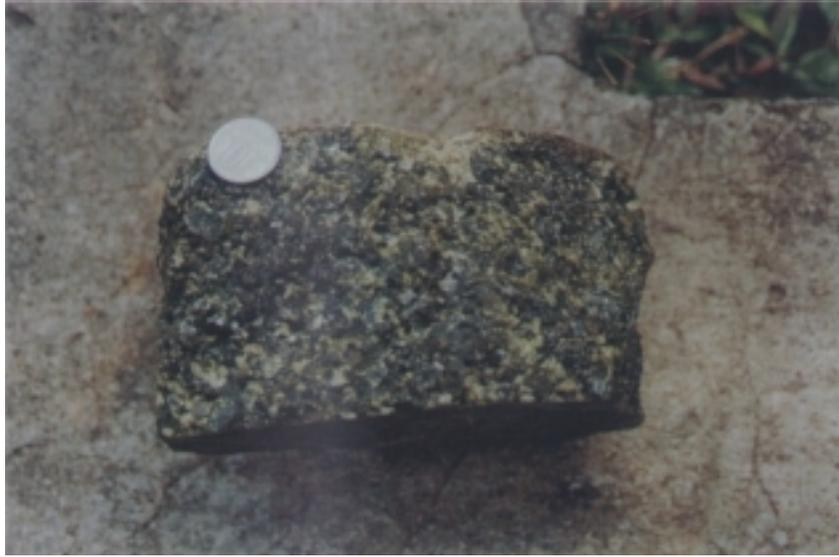
**Figura 19:** Fotografia de um típico piroxenito (bronzitito), de coloração esverdeada, granulação grossa e aspecto homogêneo.
