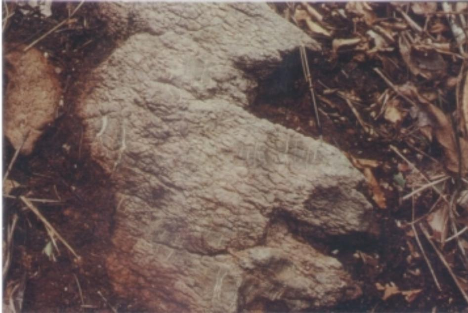
**Figura 13:** Bloco de serpentinito intensamente fraturado e com vênulas de asbesto.
