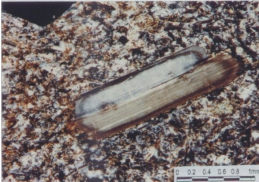
**Figura 45:** Fotomicrografia. Textura porfírica observada em hiperstênio-diabásio, definida por grande cristal de plagioclásio zonado, imerso em matriz microcristalina, (EM-212 B; 5X; NX).
