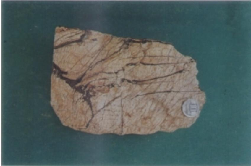
**Figura 11:** Amostra de um serpentinito fraturado típico de zona de tectonismo rúptil, situado no contato com as rochas encaixantes.
