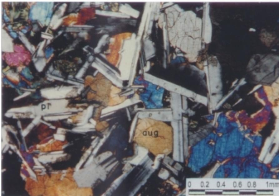
**Figura 42:** Fotomicrografia da textura óptica em augita-diabásio, formada por ripas de plagioclásio (pl) e cristais tabulares de augita (aug) (EM-218; 5X; NX).
