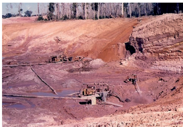
Figura 12.9 – Lavra mecanizada de cassiterita em aluviões; desmonte hidráulico (mina de Montenegro, década de 1980).
