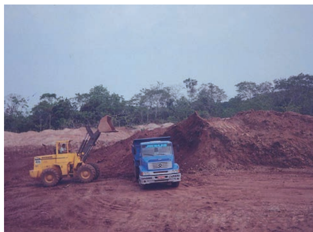
Figura 12.93 – Lavra de folhelho para indústria cerâmica (Pimenta Bueno).
