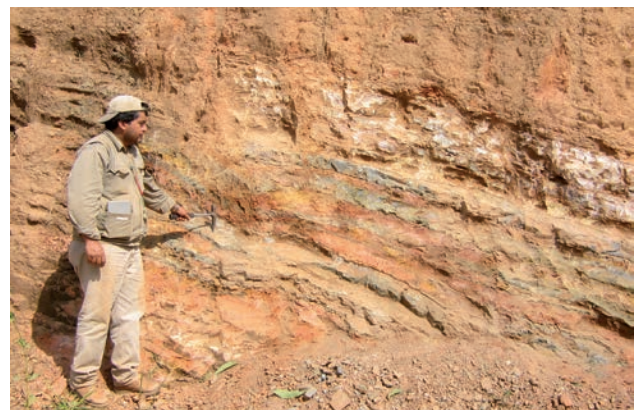
Figura 2.15 – Intercalação centimétrica de camadas de metassiltitos e metarenitos (BR 429, proximidades da vila Terra Boa).
