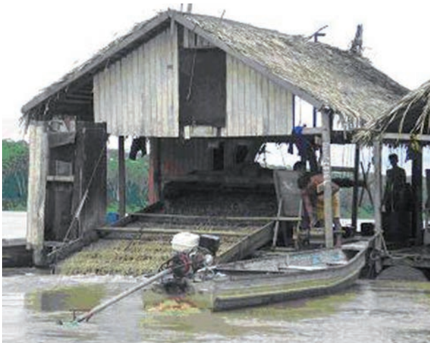
Figura 8.5 – Equipamento tipo “balsa”, com mergulhador, operando no rio Madeira.
