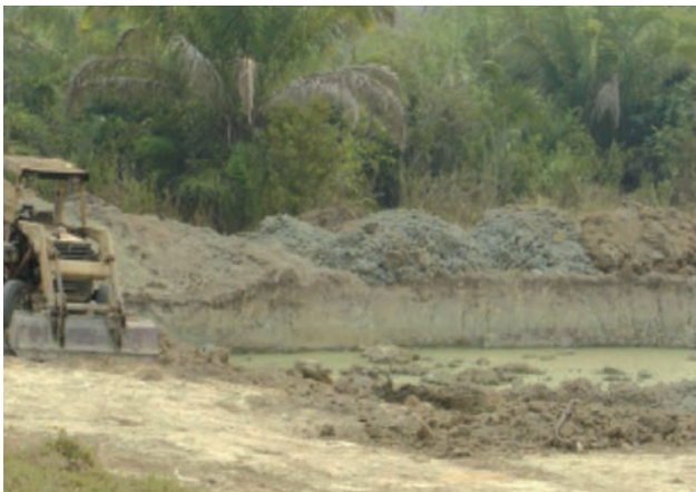
Figura 8.12 – Lavra de argila plástica acinzentada, utilizada na fabricação de tijolos, na planície de inundação da margem direita do rio Jaru.
