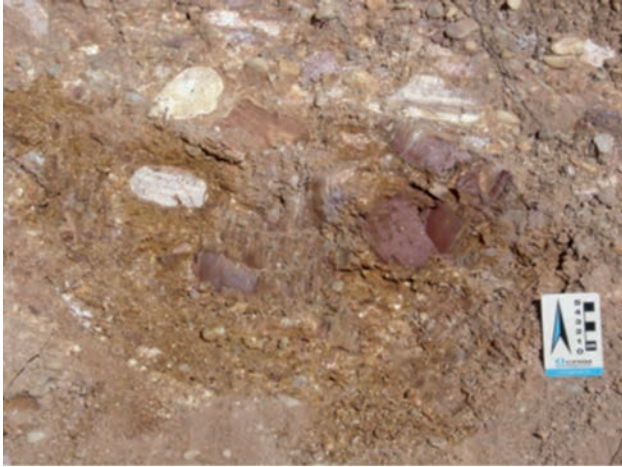
Figura 2.20 – Paraconglomerado da formação Pedra Redonda contendo seixos e calhaus de natureza diversa; matriz arenosa grossa imatura.
