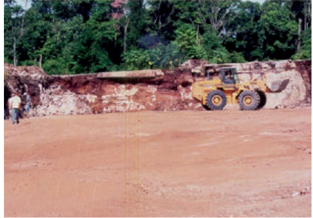
Figura 8.9 – Frente de lavra mecanizada a céu aberto de calcário dolomítico da empresa CMR (Pimenta Bueno).
