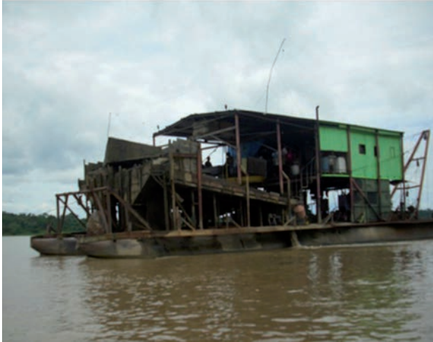
Figura 8.4 – Equipamento tipo draga operando no rio Madeira.
