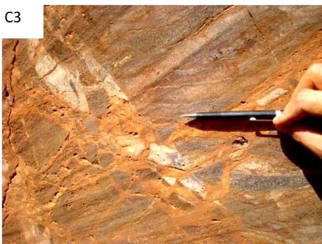
Figura 7 – Formação Ferrífera (C1) – Fotografia em seção de afloramento mostrando visão geral de formação ferrífera brechada, associada a zona de cisalhamento na direção NNE/SSW. (C2, C3 e C4) – Fotografias mostrando em corte formação ferrífera associada à zona de cisalhamento, com desenvolvimento de brechas e cimentação formada por óxi-hidróxidos de ferro e sílica. Folha Lagoa do Alegre. Casa Nova-Ba.
