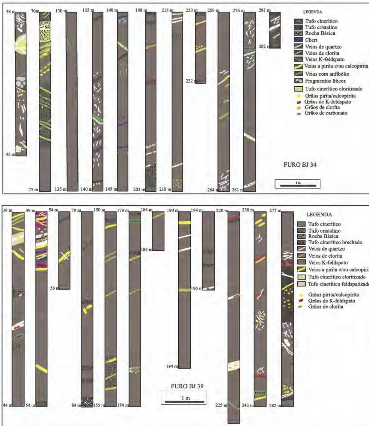
Figura 6 a) Esquema do furo estéril BJ34 da CPRM nas profundidades amostradas por Guimarães (2007). Os dados de 130m a 145m foram compilados de Seer (1985); b) Esquema do furo mineralizado BJ39 da CPRM nas profundidades amostradas por Guimarães (2007).
