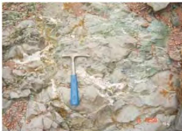
Figura 16 Stockwork de barita e calcopirita alterada para malaquita em arenito.
