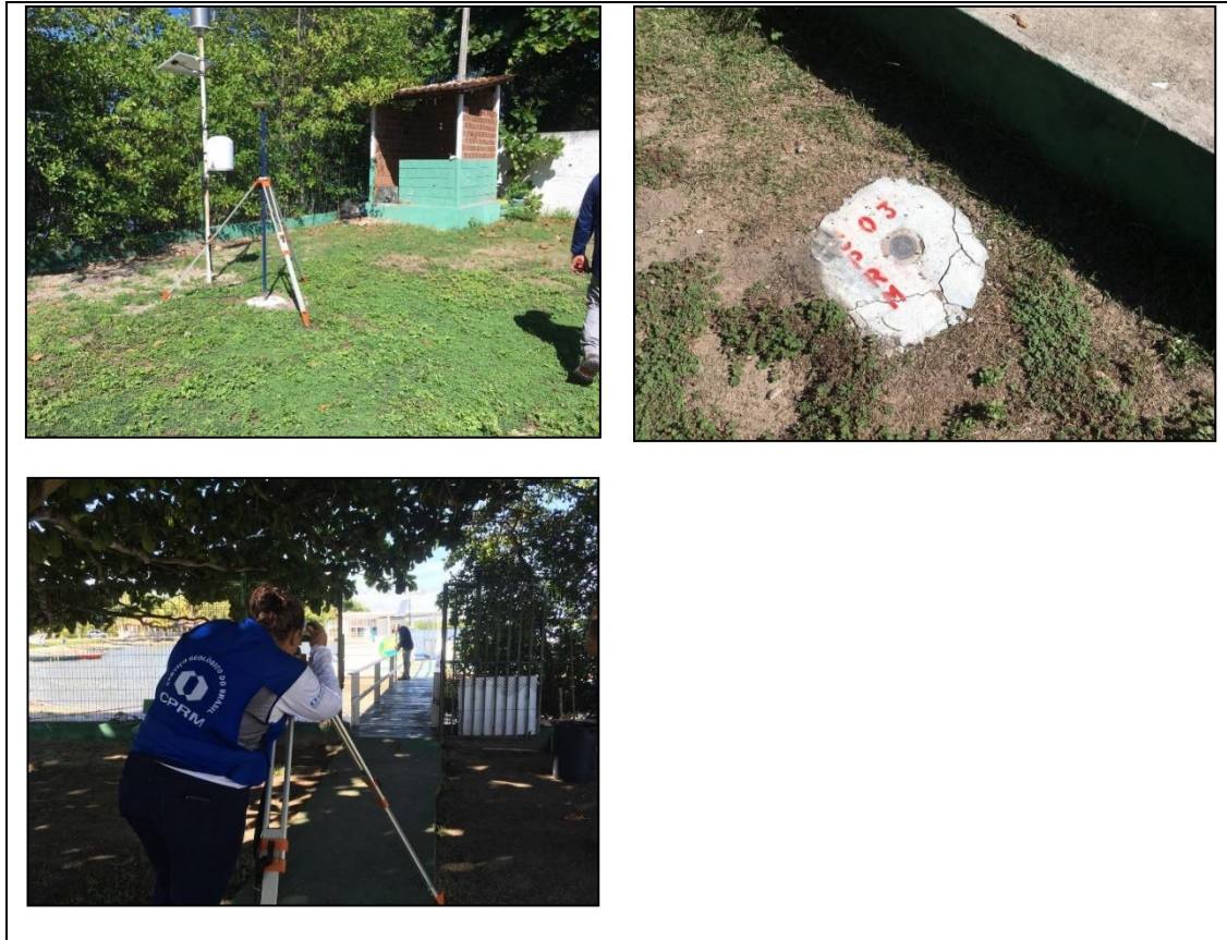
Figura 9. Estação PCD localizada no IMA sendo os RNs (RN-CPRM-03 e RN-CPRM-04) rastreados por GPS geodésico e o nivelamento do sensor do radar da PCD.
