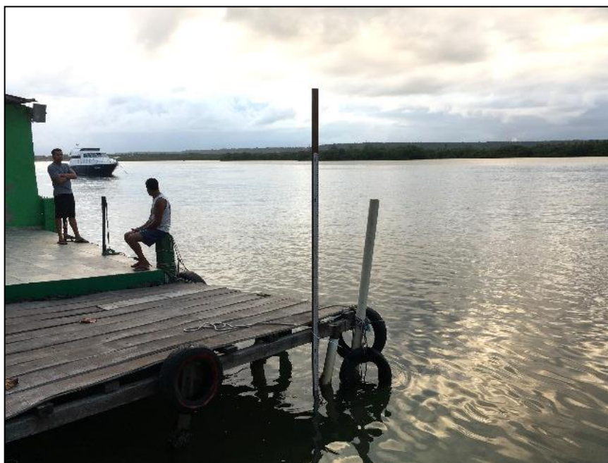
Figura 6. Régua de maré de 3 metros instalada na Marina Lago Mar, no canal de acesso a lagoa de Mundaú.
