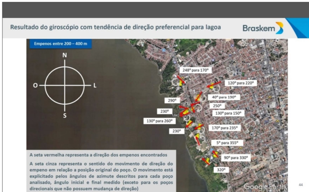
Figura 10 – Deformações de tubulações de poços da Braskem encontradas entre 200 e 400 metros com 11 sentidos diferentes de empenos (slide 44 da apresentação “INFORMAÇÕES DA BRASKEM” de abril/2019).
