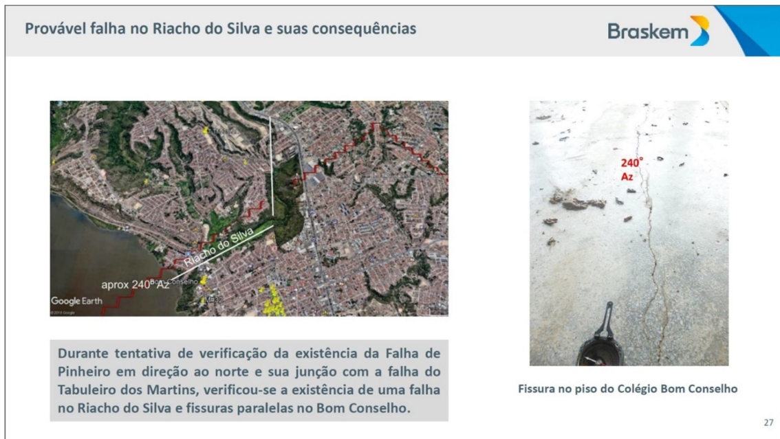
Figura 16 – Identificação da Falha Riacho do Silva com 240° Az. Esta falha possui registro no piso do Colégio Bom Conselho localizado nas proximidades da área de mineração e tem a mesma direção de falhas identificadas pelo método gravimétrico. Fonte: slide 27 da apresentação “INFORMAÇÕES DA BRASKEM” de abril/2019.
