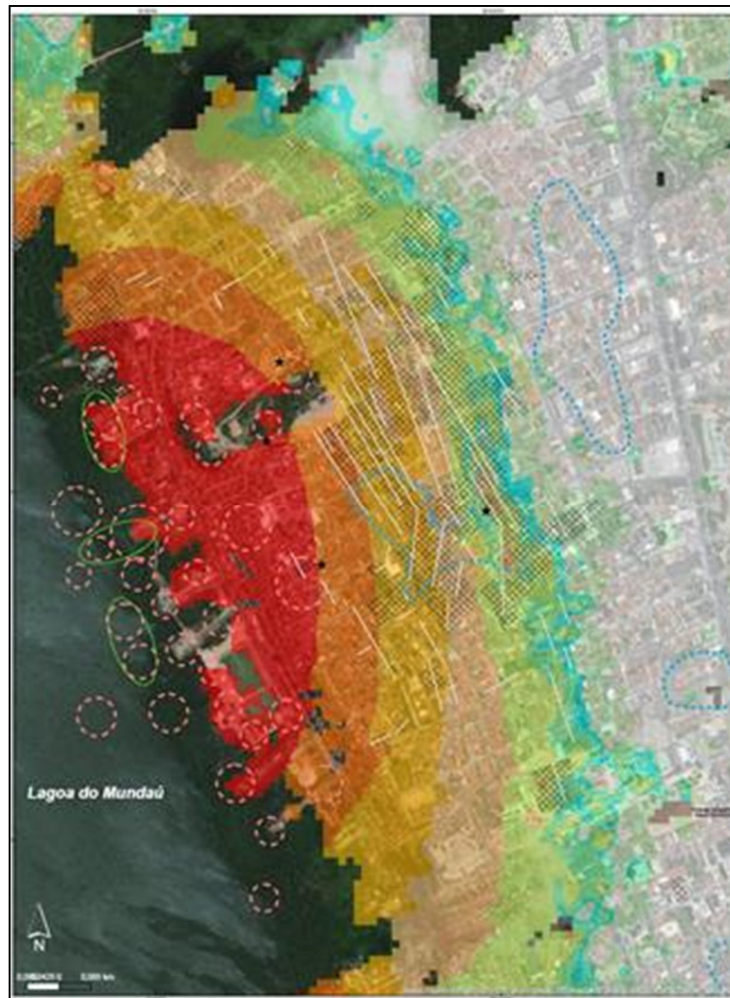
Figura 28 – Mapa de Integração de Processos de Instabilidade do Terreno apresentando as faixas de maior aceleração do processo de subsidência e as áreas afetadas por rachaduras e trincas, além das minas de sal.
