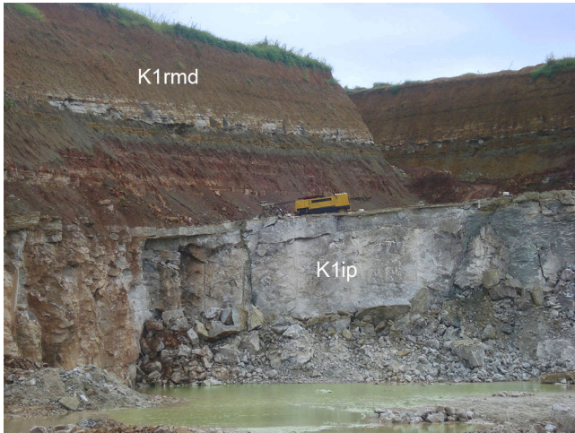
Figura 4.2 - Frente de lavra mostrando as lentes de gipsita da Formação Ipubi (K1ip) na base, sobreposta pela Formação Romualdo (K1rmd).
