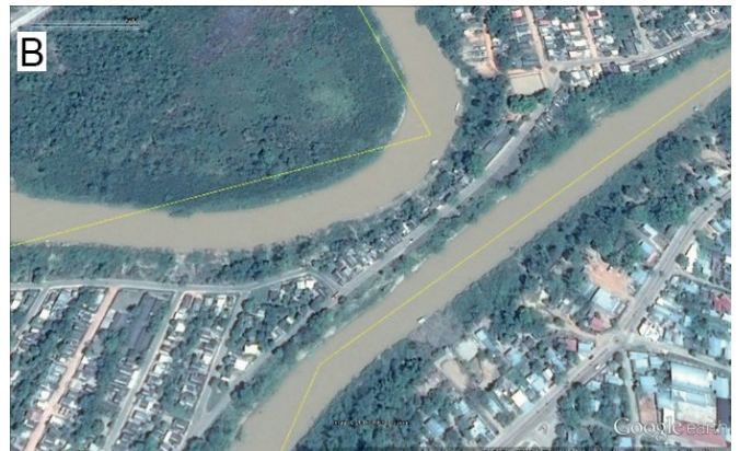
FIGURAS 8 - a) Detalhe do setor do Rio Acre em processo de avulsão no ano de 2005; b) Detalhe do setor do Rio Acre em processo de avulsão no ano de 2013. Medições preliminares tomadas por meio de sucessivas imagens de satélite e levantamento de campo demonstram que, em uma década, o setor estrangulado foi reduzido de 60 para 25 metros. Fonte: Google Earth, imagens de 2005 e 2013.
