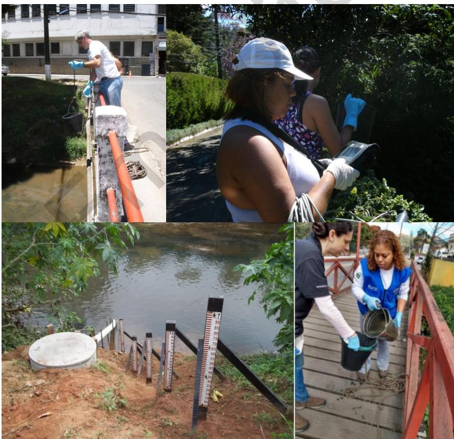
Figura 31, 32, 33 e 34 - Coleta de amostras na estação Pedro do Rio, medição com sonda multiparamétrica na estação Rocio ponte, estrutura para sonda fixa de qualidade de água na estação Parque Petrópolis e coleta de amostras na estação Parque Petrópolis respectivamente.
