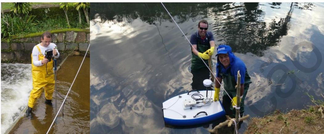
Figuras 35 e 36 - Medição de vazão nas estações Rocio e Parque Petrópolis com Flow Tracker e S5 respectivamente.
