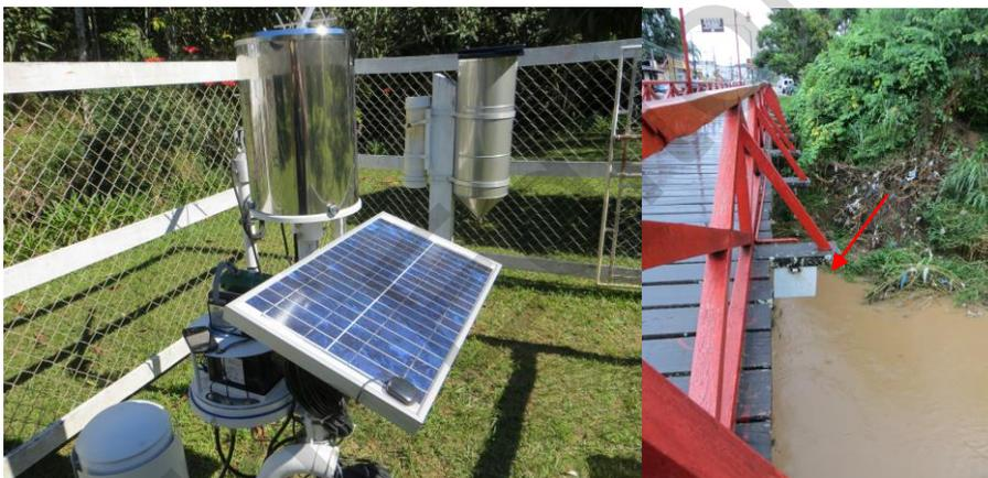
Figura 27 e 28 -Pluviômetro convencional e PCD de chuva, com telemetria, na estação Rocio BD e radar instalado sob a ponte na estação parque Petrópolis respectivamente.
