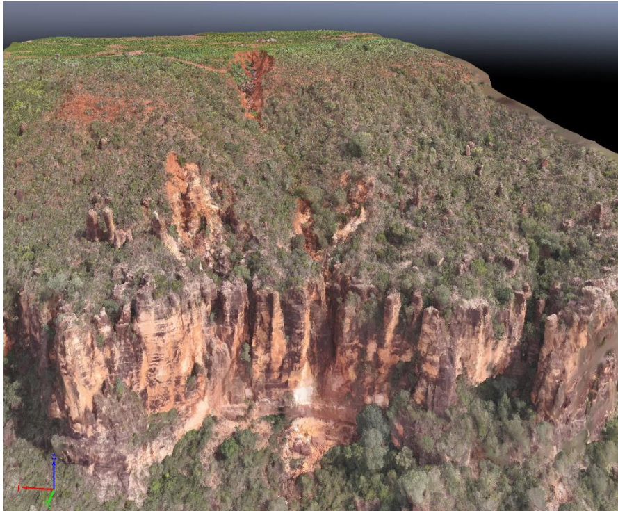
Figura 17: Modelo tridimensional da feição erosiva 2 obtido por meio do processamento de imagens capturadas por veículo aéreo não tripulado. Fonte: elaborado pelos autores.
