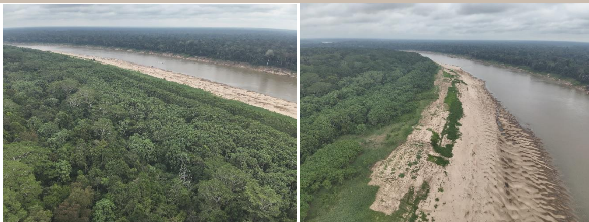
Figura 18: Locus da proposta de realocação da comunidade Santa Fé em barra de acreção do rio Purus. Solos arenosos e firmes em margem com grau praticamente nulo de erosão fluvial e recuo erosivo, conforme proposta de tipologia apresentada neste relatório. Fonte: Autores.
