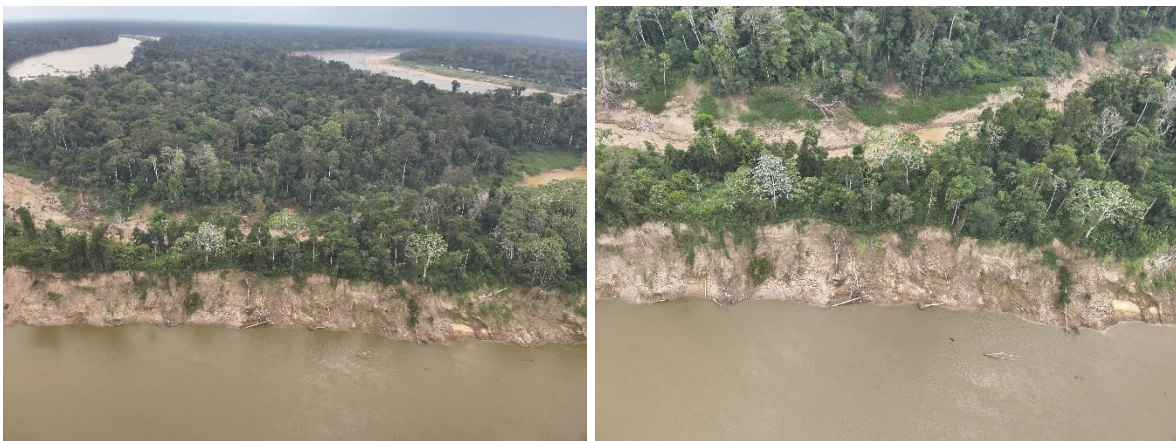
Figura 14: Margem côncava do rio Purus apresentando, em primeiro plano, barranca com alto grau de erosão fluvial e recuo erosivo, conforme proposta de tipologia apresentada neste relatório. Ao fundo, à esquerda, segmento do lago Catipari (antigo lago de meandro abandonado), suspenso em relação à calha do rio Purus, situada à direita. Fonte: Autores.
