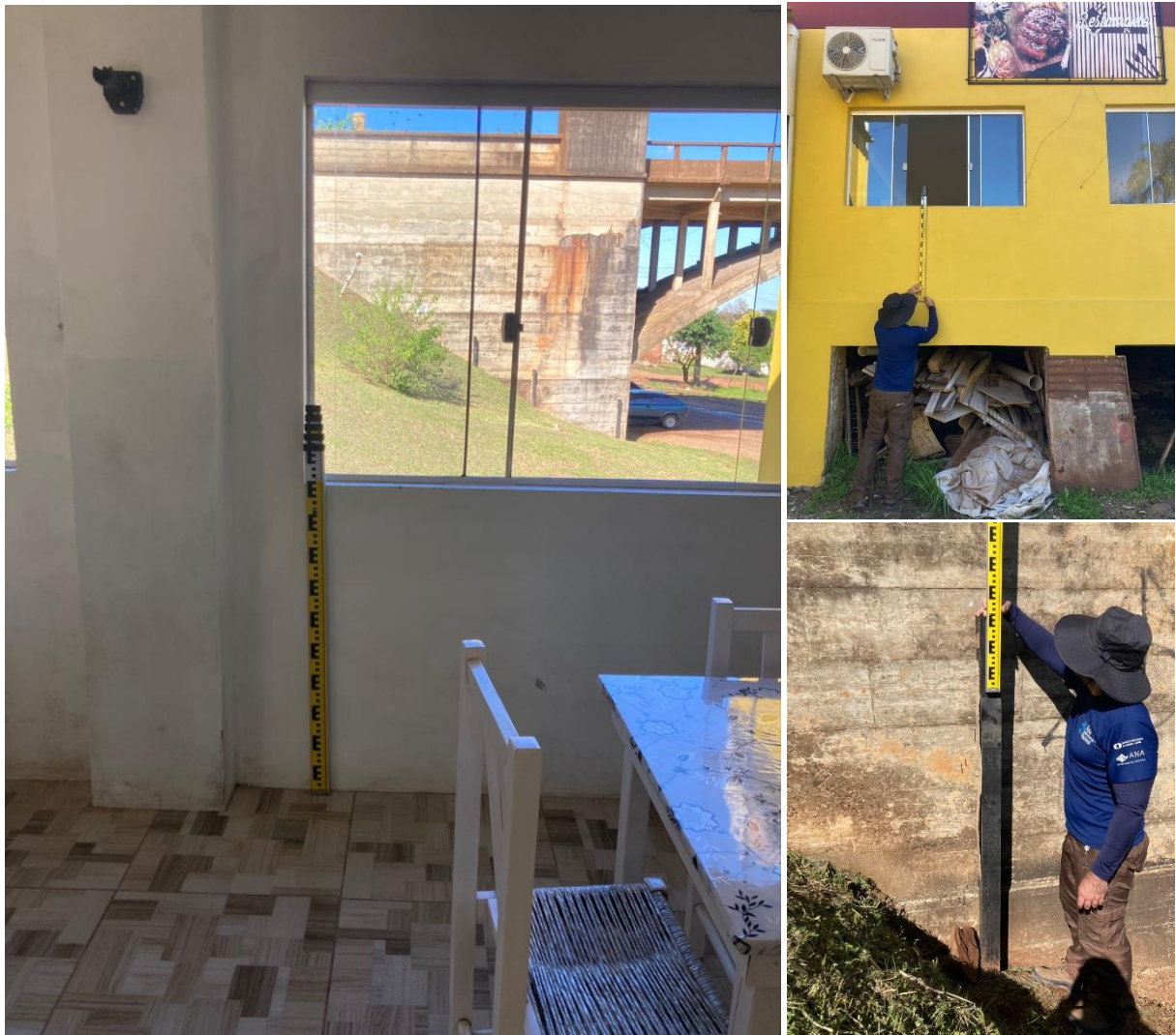
Figura 12. Marca de cheia nivelada do rio Ibicuí, no município de Manoel Viana / RS, referente a estação fluviométrica Manoel Viana (76560000).
