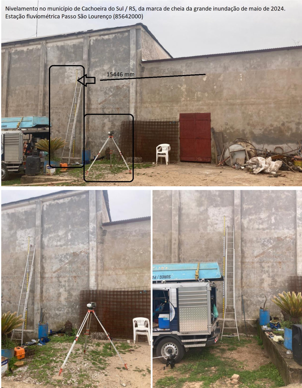
Figura 13. Marca de cheia nivelada do rio Jacuí, no município de Cachoeira do Sul / RS, referente a estação fluviométrica Passo São Lourenço (85642000).
