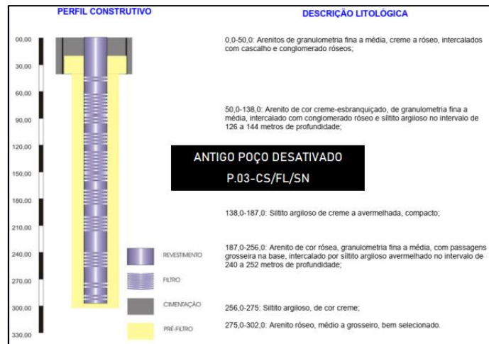
Figura 5: Características construtivas do poço P03-CS/FL/SN
